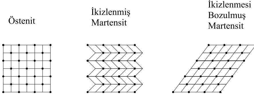
Şekil 2.3. ŞHA'da östenit ve martensit fazlarının mikroskobik görünüşleri
