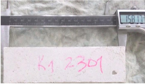
Resim 3.28. Onarım harçlarının elektronik kumpas ile boyut ölçümü
