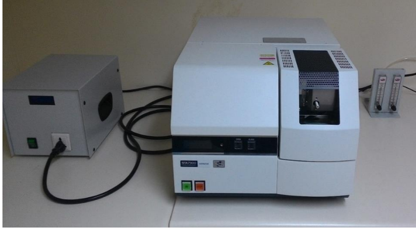
Resim 3.32. Termogravimetrik ölçümlerde kullanılan Hitachi marka TG-DTA cihazı
