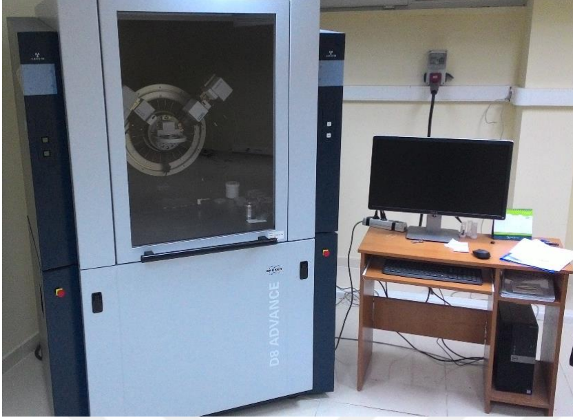
Resim 3.14. Mineralojik analizde kullanılan X-ışınları cihazı
