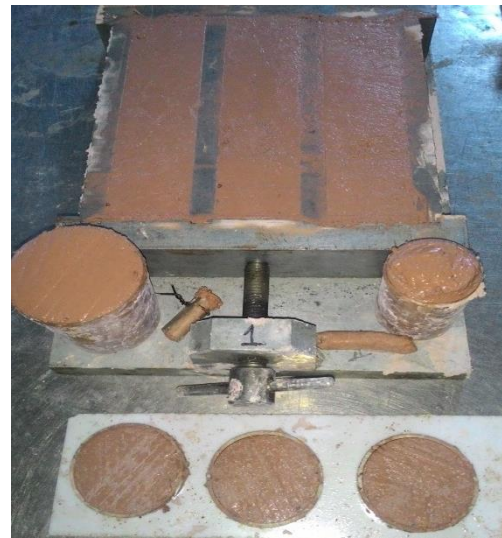
Resim 3.23. Onarım harçlarının çelik kalıplara yerleştirilmesi ve deney kalıp seti
