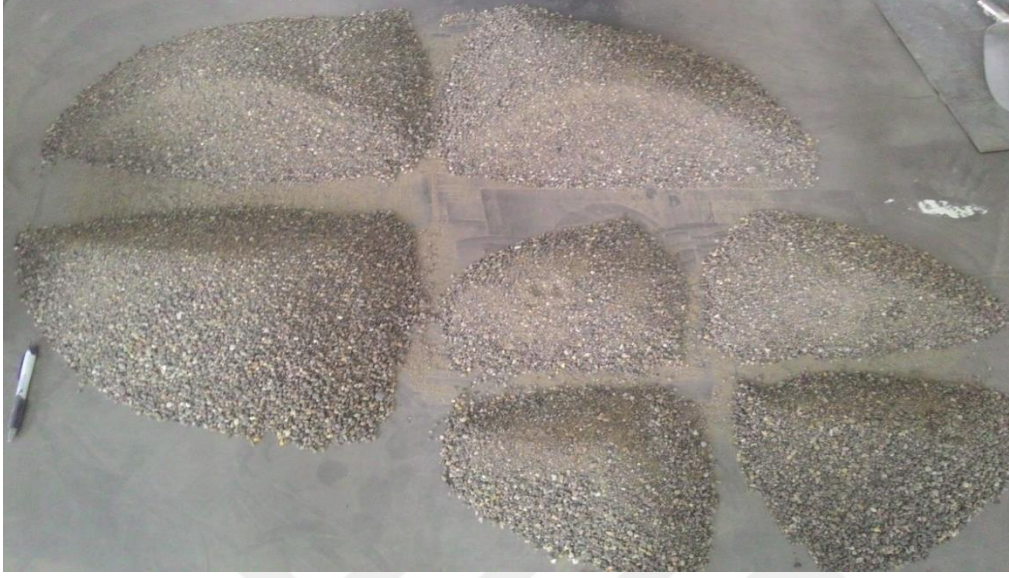
Resim 3.21. Kazan-Ovaçay agregasının çeyrekleme metoduyla bölünmesi
