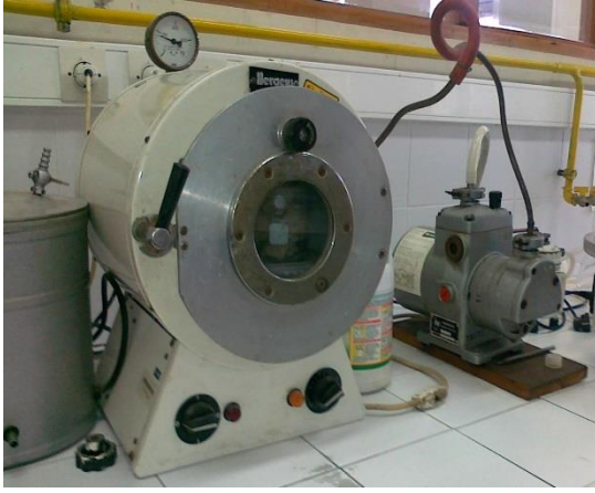
Resim 3.10. Vakum aleti ve Arşimet terazisi
