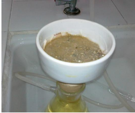
Resim 3.12. Seyreltik asitte bekletilen numunelerin filtrasyonu ve kurutulması
