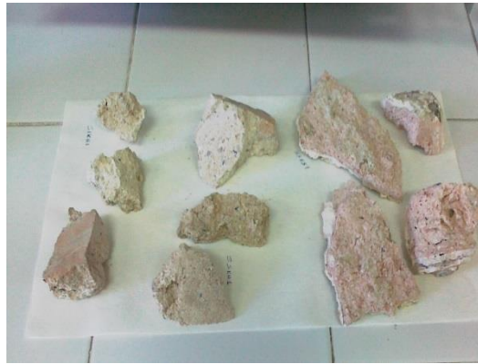
Resim 3.9. Özgün örgü harç numunelerin etüvde kurutulması
