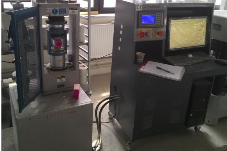
Resim 3.30. Harçlar için tasarlanmış eğilme-basınç dayanım cihazı ve kontrol ünitesi
