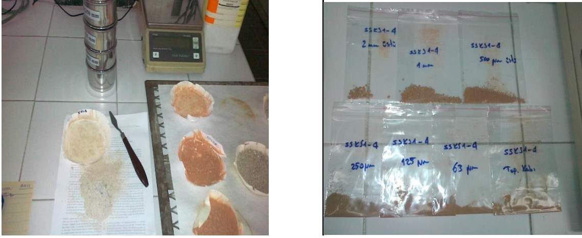
Resim 3.13. Agregaların eleklerden elenmesi ve sınıflandırılması
