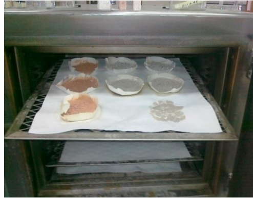
Resim 3.12. Seyreltik asitte bekletilen numunelerin filtrasyonu ve kurutulması
