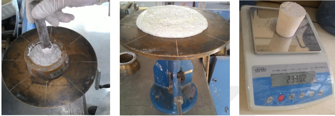
Resim 3.25. Yayılma tablası deneyi ile taze harcın birim hacim ağırlık deneyi
