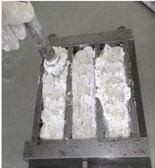
Resim 3.23. Onarım harçlarının çelik kalıplara yerleştirilmesi ve deney kalıp seti
