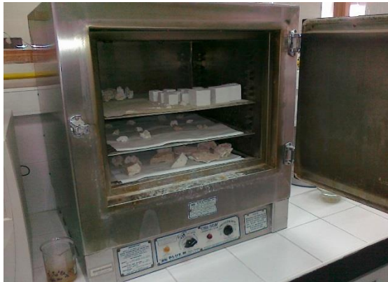
Resim 3.9. Özgün örgü harç numunelerin etüvde kurutulması
