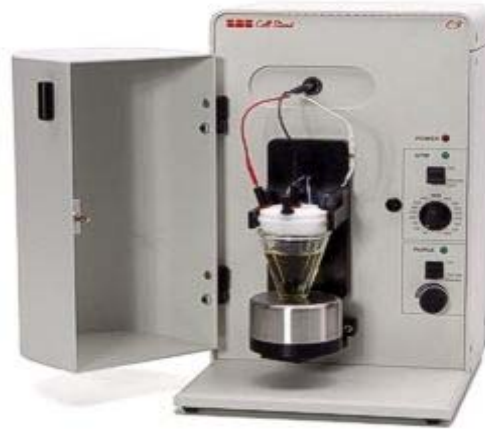
Şekil 3.5.1.1. Elektrokimyasal ölçümler için kullanılan üç elektrotlu hücre sistemi
