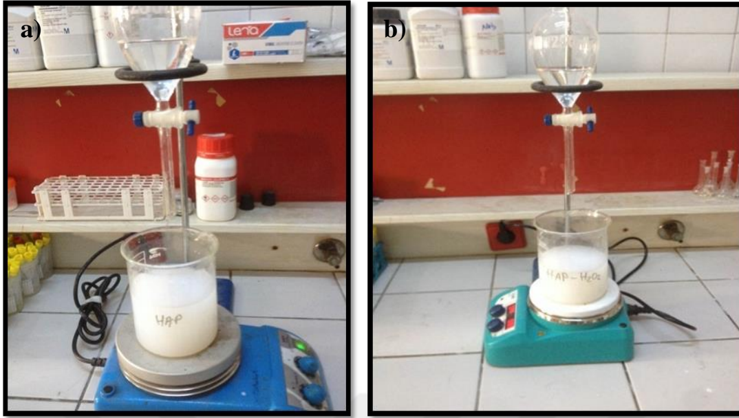
Şekil 4.3. Birlikte çöktürme yöntemi esnasında alınan görüntüler: a) Hidroksiapatit sentezi ve b) Hidroksiapatit-H 2 O 2 sentezi
