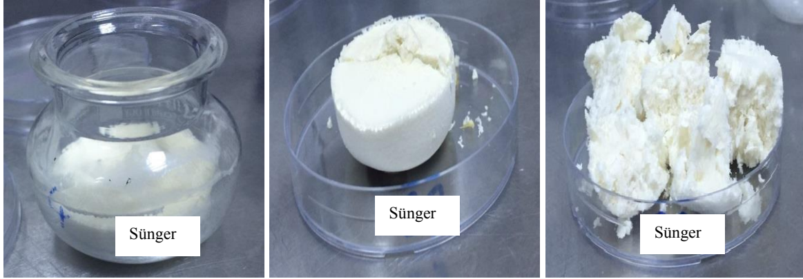
Resim 9.1. Sünger numunelerin liyofilizasyon flaskında ve flasktan çıkarıldıktan sonraki görünümleri
