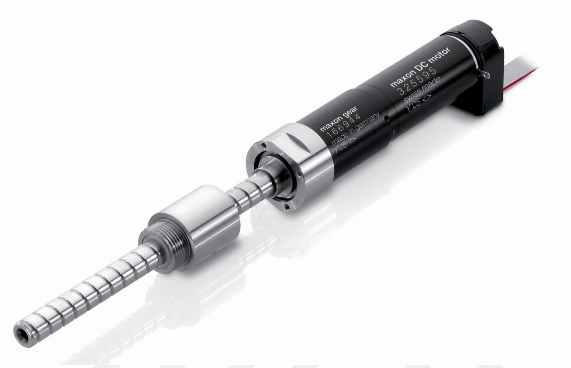
Resim 6.1. Doğru akım tahrik motoru – gezegen dişli kutusu - bilyalı vida – artımsal enkoder bütünü [19].
