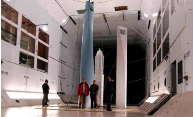
Resim 5.18. Reynolds sayı çalışma modeli, 1:85 ölçek (RWDI) (Zeljic, 2010)
