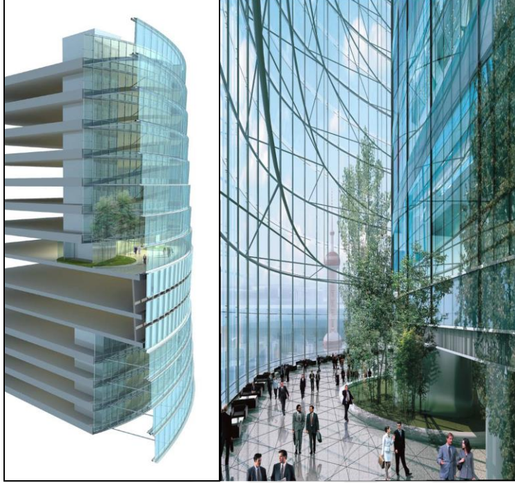
Şekil 5.19. Çift kabuk cam cephe kesit perspektifi ve gökyüzü lobilerinden iç mekân görüntüsü (Gensler, 2010)
