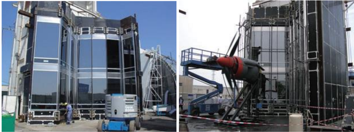
Resim 5.10. (a) Kule test modeli. (b) Dinamik su sızdırmazlık testi için kule test modeli (Weismantle ve diğerleri, 2007)
