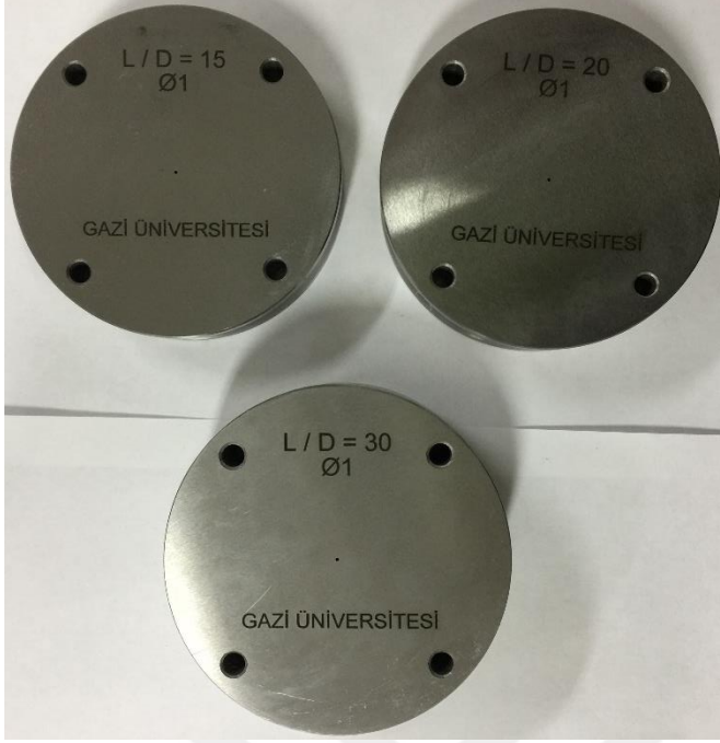
Şekil 7.16. Üretilen 1 mm çaplı kalıp (3 adet)
