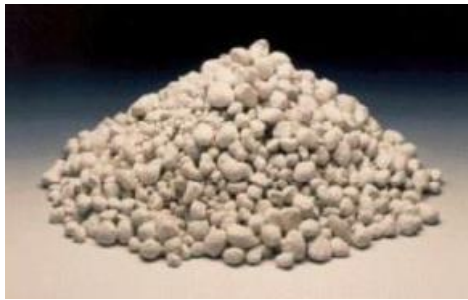
Şekil 2.2. Soğumada meydana gelen çarpılma olayını önleyici kaolin maddesi
