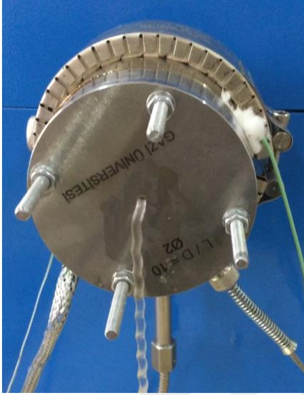
Şekil 8.15. Eriyik malzemenin kırılarak çıkması (melt fracture)
