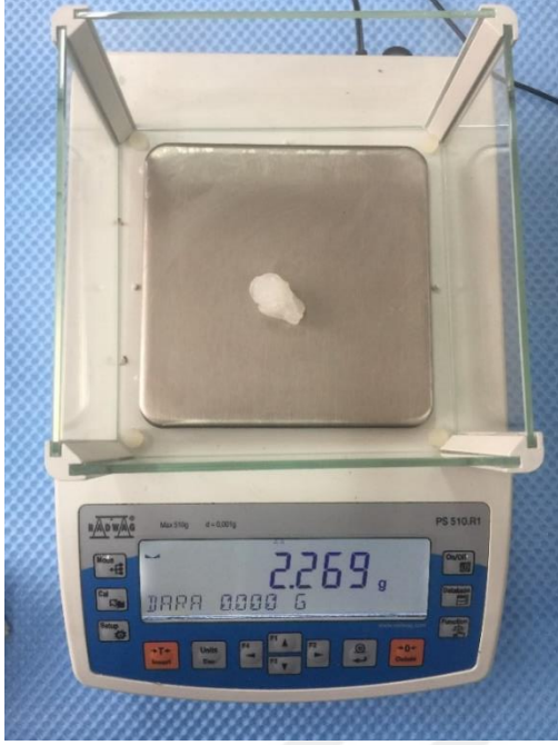
Şekil 7.31 Ekstrüde edilen PP malzemenin ağırlığının ölçülmesi
