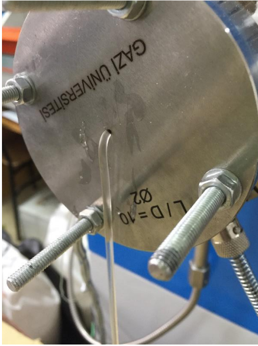
Şekil 7.30. Eriyik PP malzemesinin kalıptan çıkışı
