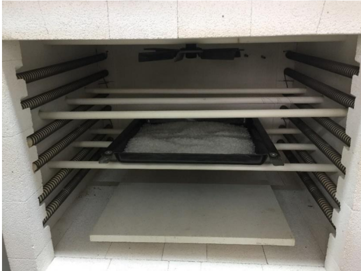
Şekil 7.29. Etüv fırında PP malzemenin nem alma işlemi
