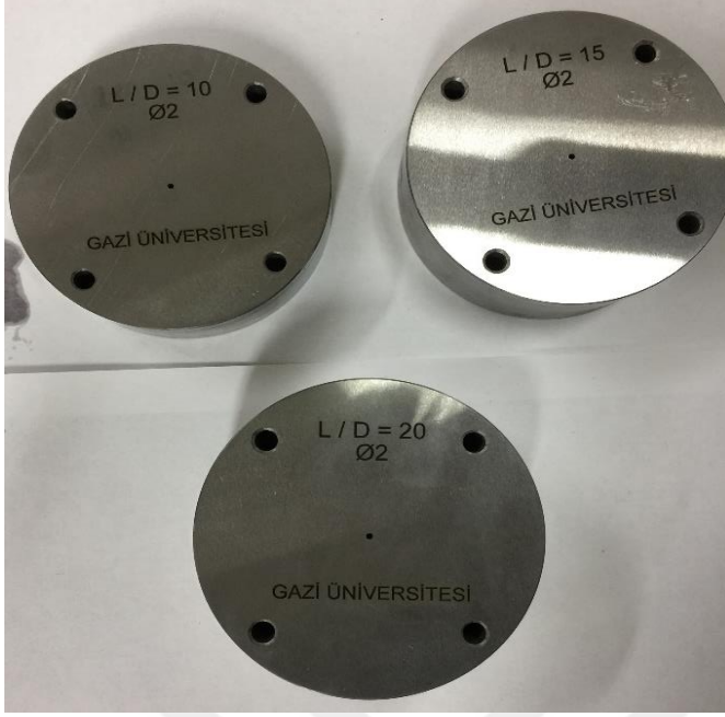
Şekil 7.18. Üretilen 2 mm çaplı kalıp (3 adet)
