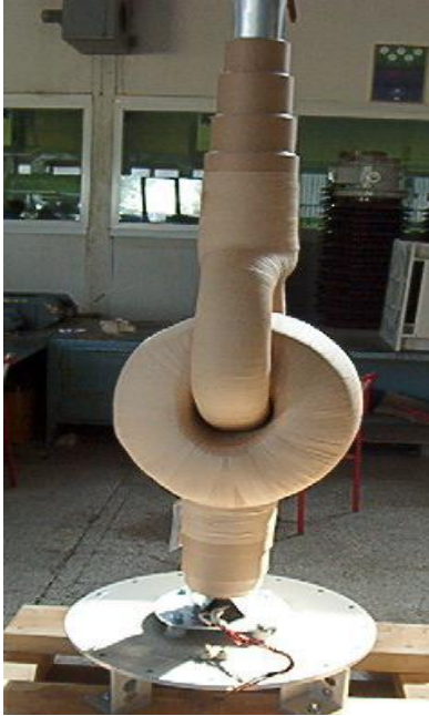
Resim 4.4. Akım transformatörü aktif kısmı
