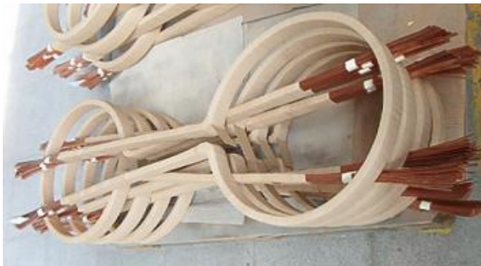
Resim 2.2. Akım transformatörü primer sargıları
