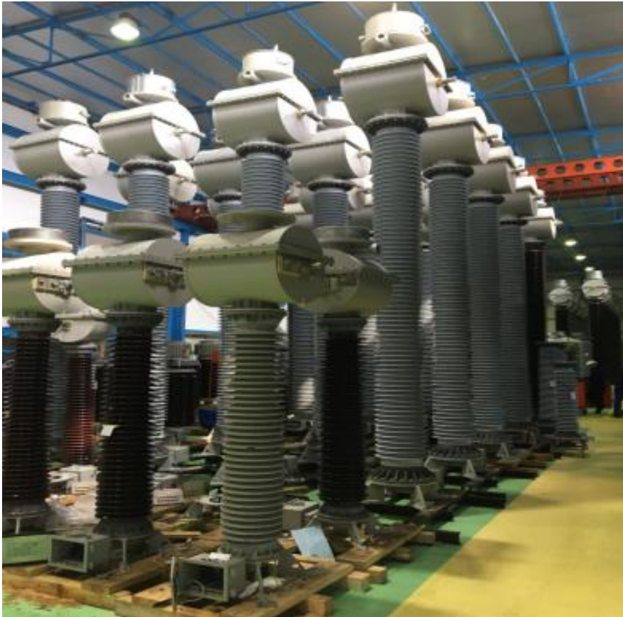
Resim 3.3. Yüksek gerilim kafa tipi akım transformatörleri
