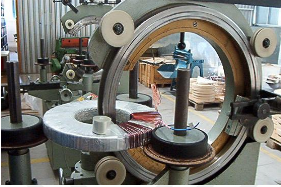
Resim 4.5. Otomatik makine ile sekonder sarım
