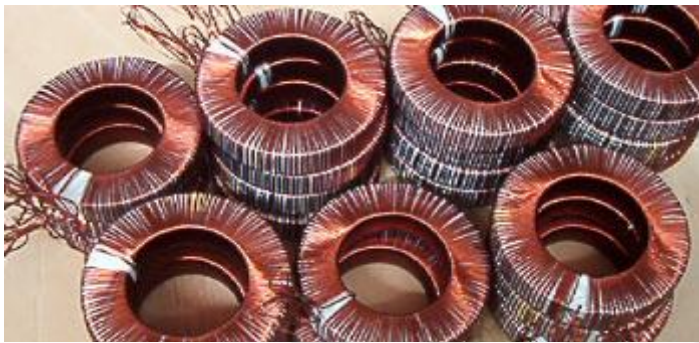
Resim 2.1. Akım transformatörü sekonder sargıları
