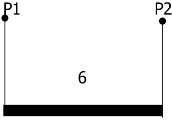
Şekil 4.8. Yüksek gerilim tek oranlı akım transformatörü için primer sargı diagramı
