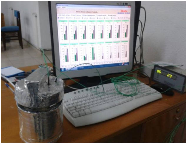
Resim 3.4. Özgül ısı deney düzeneği
