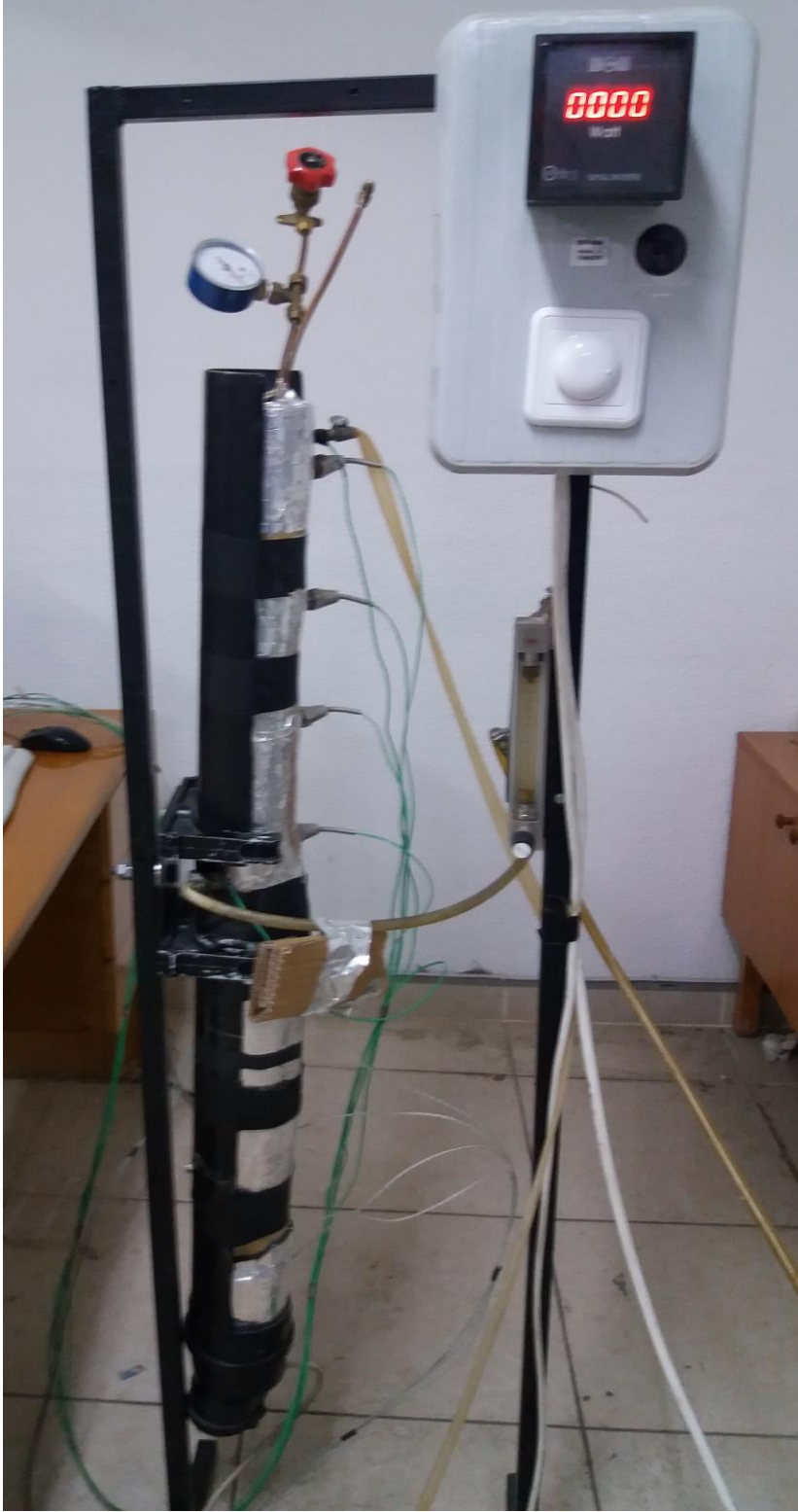
Resim 3.7. Isı borusu deney düzeneđi
