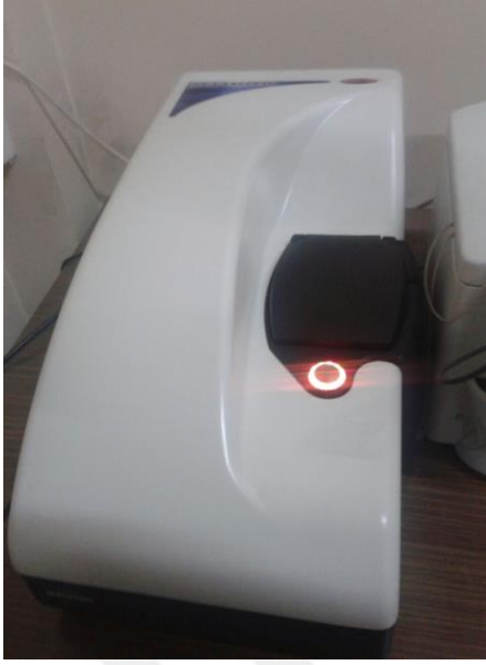
Resim 3.3. Nano boyut ve zeta potansiyeli ölçüm cihazı
