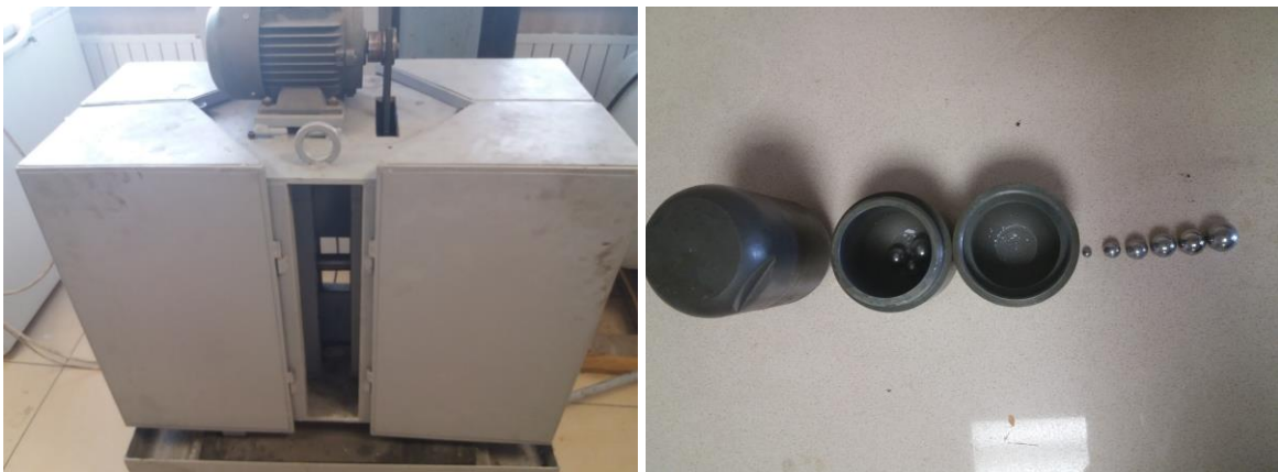
Resim 3.1. a: Spex tipi yüksek enerjili öğütücü b: Reaktör ve çelik bilyeler
