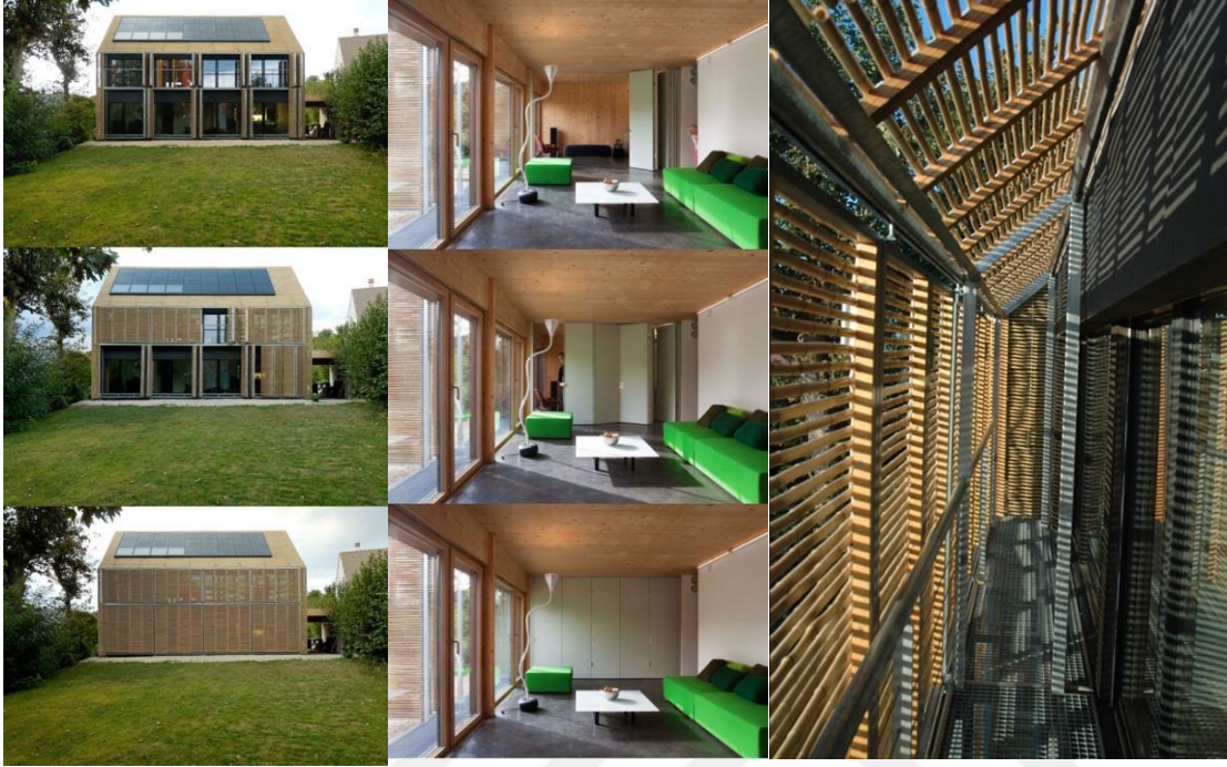
Resim 3.17. İç mekanda hareketli duvarlarla serbest ev planı-dış mekanda hareketli bambu panjur kullanımıyla güneş kontrolü-balkon (URL-50; URL-51)
