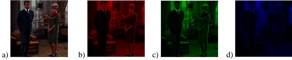
Resim 4.5. Renkli deney görüntüsü ve RGB bileşenleri (a) Orijinal deney görüntüsü, (b) R bileşeni, (c) G bileşeni, (d) B bileşeni
