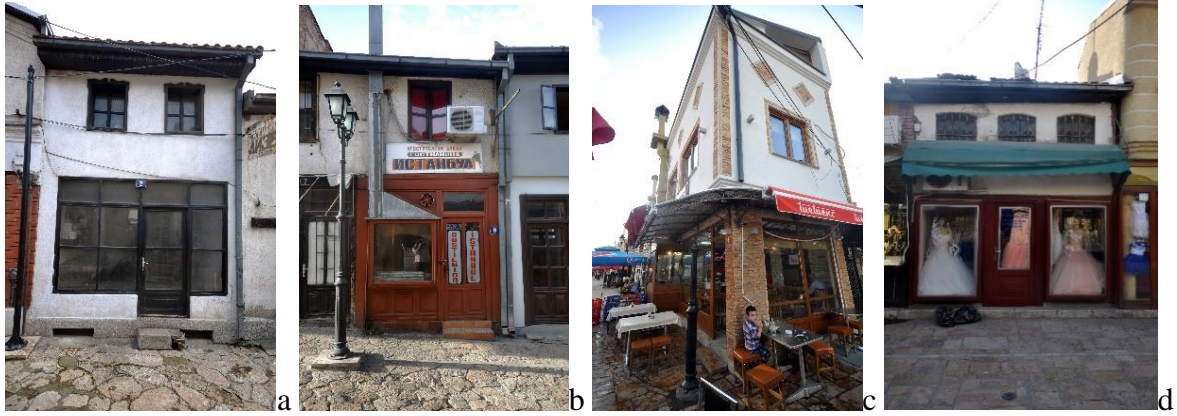
Resim 7.16. Vitrin biçimlenmesi tipoloji örnekleri: (a) P.9159 - Çıkmasız, Ara Boy; (b) P.9163 - Ön Tek/Yan Çıkma, Yarım Boy; (c) P.6287 - İki Cephe Tek Çıkma; (d) P.6308 - Ön İkiz Çıkma, Tam Boy
