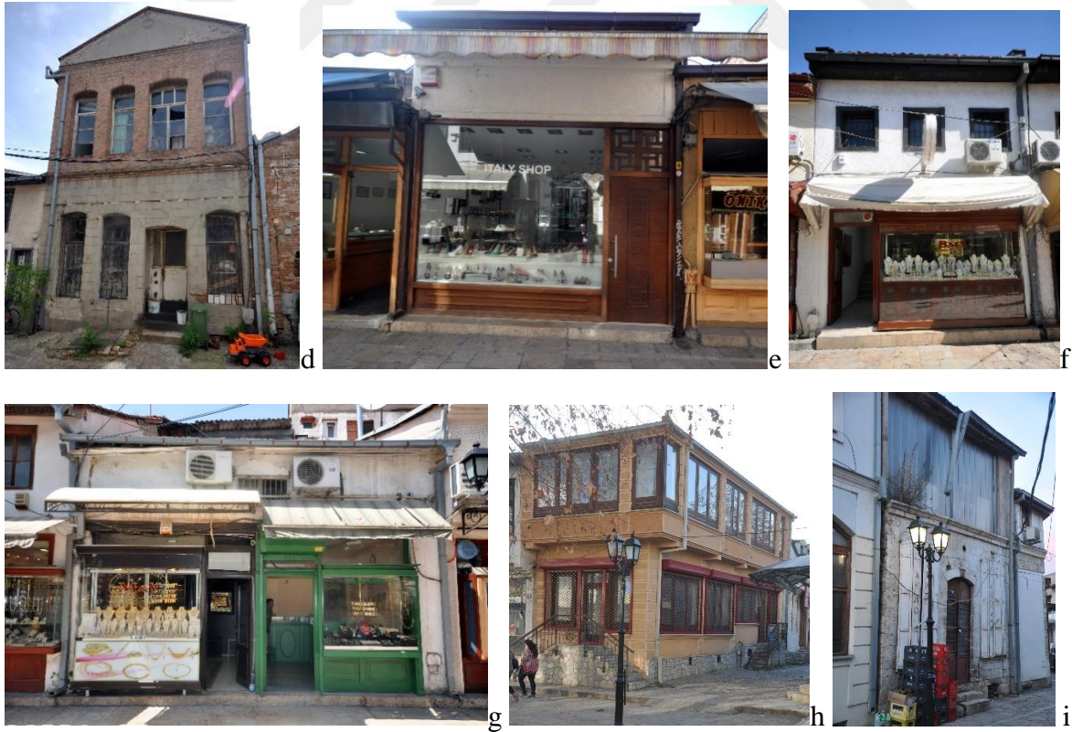
Resim 7.21. (d) P.6362, kemerli pencere; (e) P.9266, penceresiz; (f) P.6394, kare pencere; (g) P.6318, küçük pencere; (h) P.9395, büyük veya geniş pencere; (i) P.6340, yıkılmış üst kat biçimlenme örnekleri
