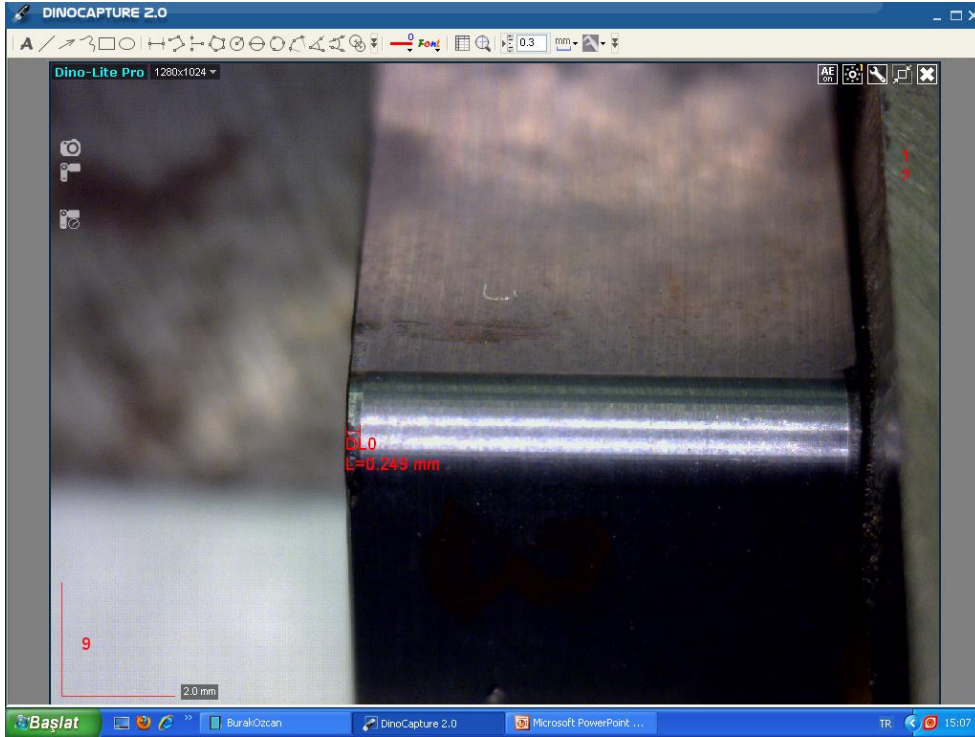
Şekil 5.4. Dino-Lite mikroskobunda kesici takımlarda oluşan aşınmasının ölçülmesi
