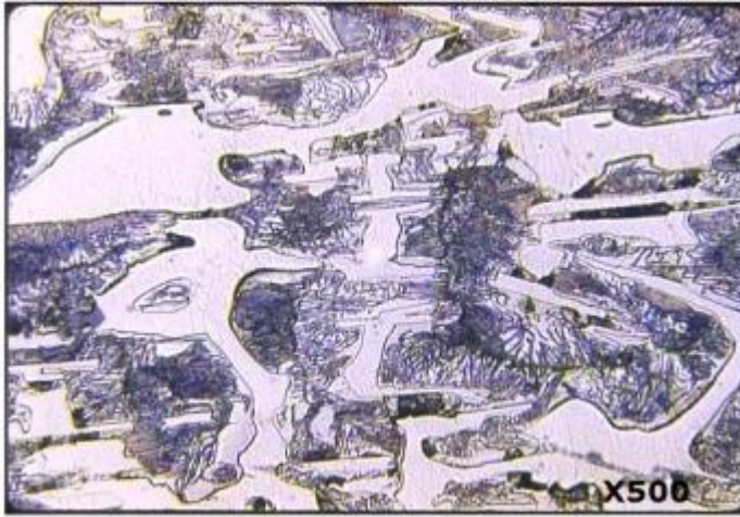
Şekil 3.10. Tipik beyaz dökme demir yapısı
