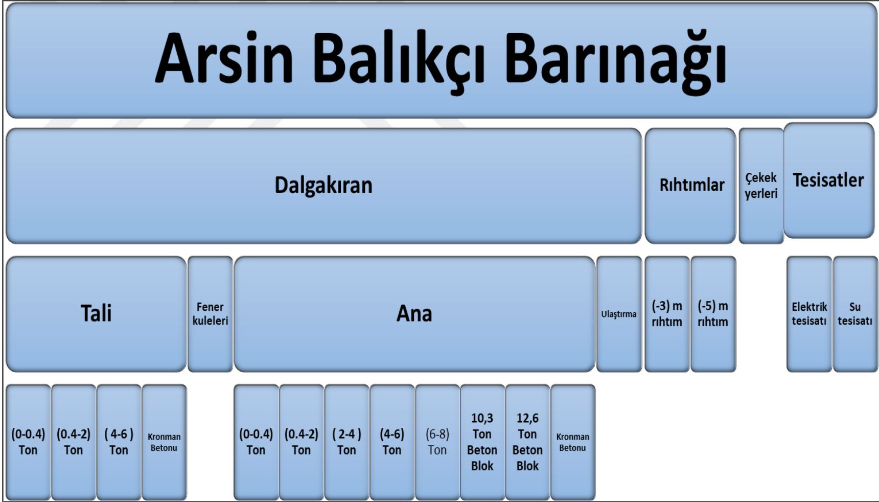
Şekil 6.3. Arsin balıkçı barınağı'na ait iş ayrım yapısı
