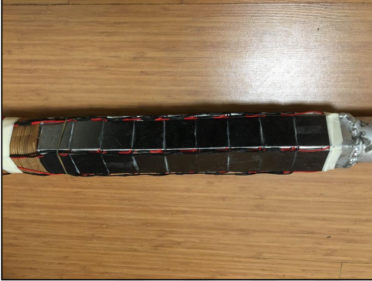
Resim 5.4. TEJ montajları tamamlanmış TBS iç baca borusu
