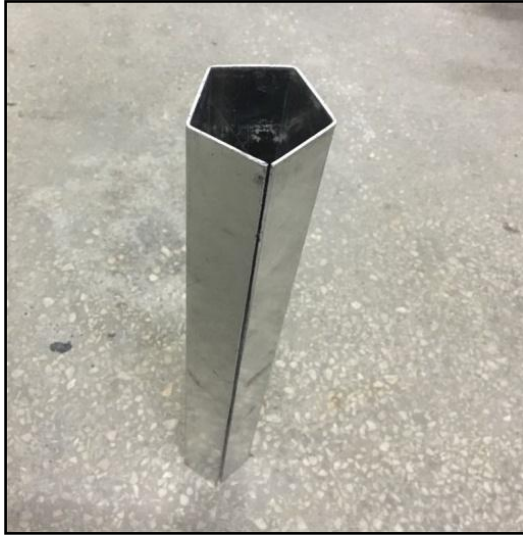
Resim 5.2. Tasarımı ve imalatı yapılan iç baca borusu
