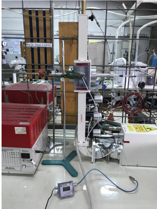
Resim 3.2. Mikrodalga reaktör oyuğu, lazerli pirometre ve online bağlı GC cihazı
