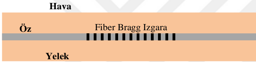
Şekil 3.12. Fiber Bragg ızgara yapısı
