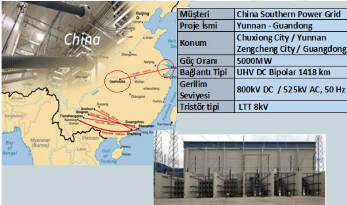
Şekil 3.5. Çin'de Yun-Guang arasındaki HVDC iletim projesi
