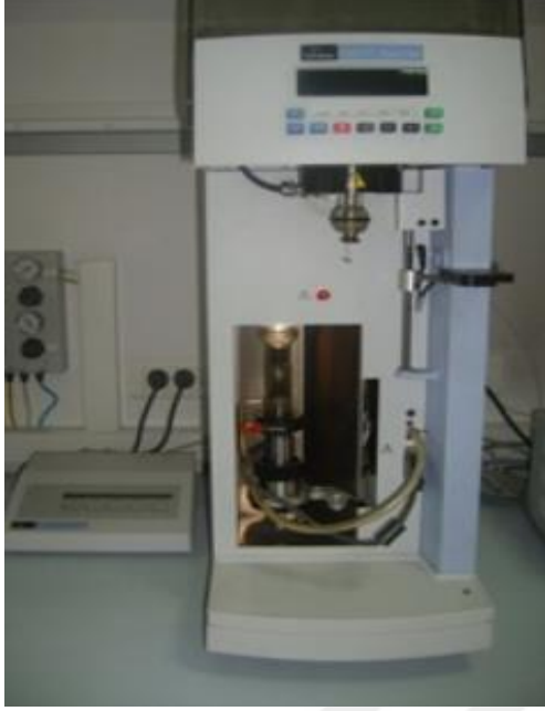
Resim 4.3. TGA Cihazı (ODTÜ-MERLAB)
