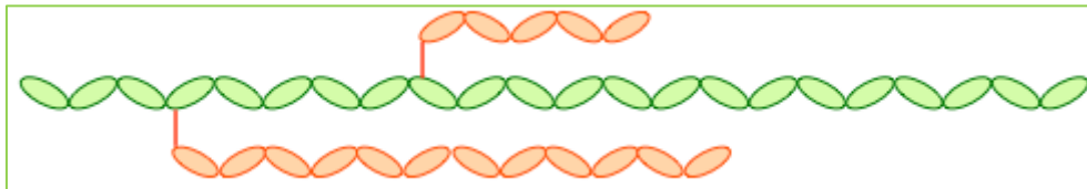
Şekil 3.9. Aşı kopolimerin zincir yapısı
