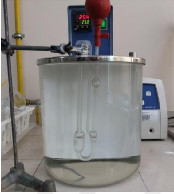
Resim 5.5. Termostatlı su banyosunda Ubbellohde viskozimetresi
