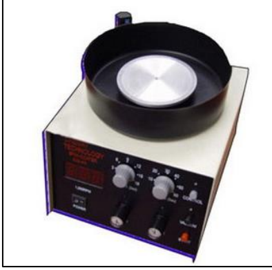
Resim 2.1. Genel uygulamalar için taşınabilir bir döndürme kaplayıcı
