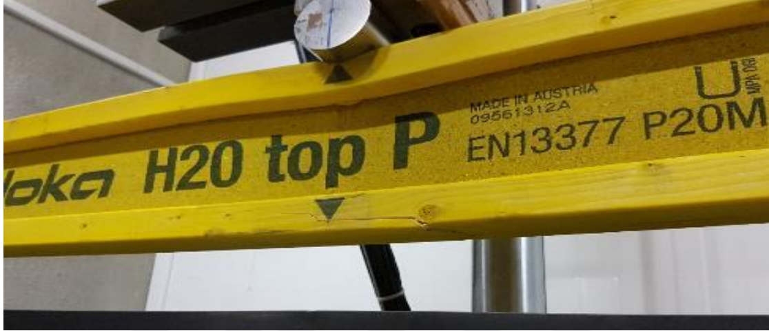
Resim 4.3. Deney elemanı-1 alt başlık kısmında çatlak oluşumu
