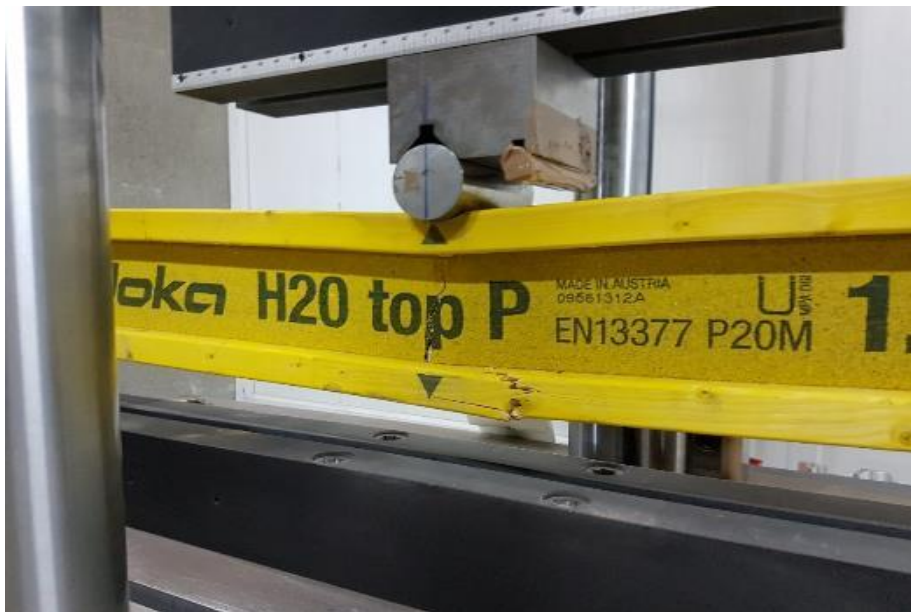
Resim 4.4. Deney elemanı-1’de oluşan yatay düzleme dik hasar oluşumu
