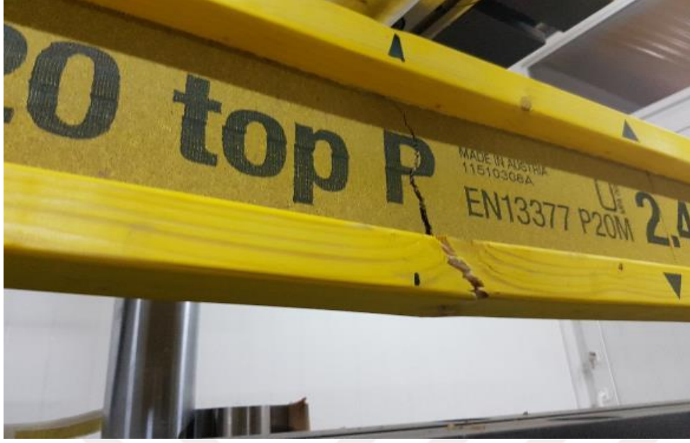
Resim 4.29. Deney elemanı-6 oluşan çatlağın alt kısımda artması
