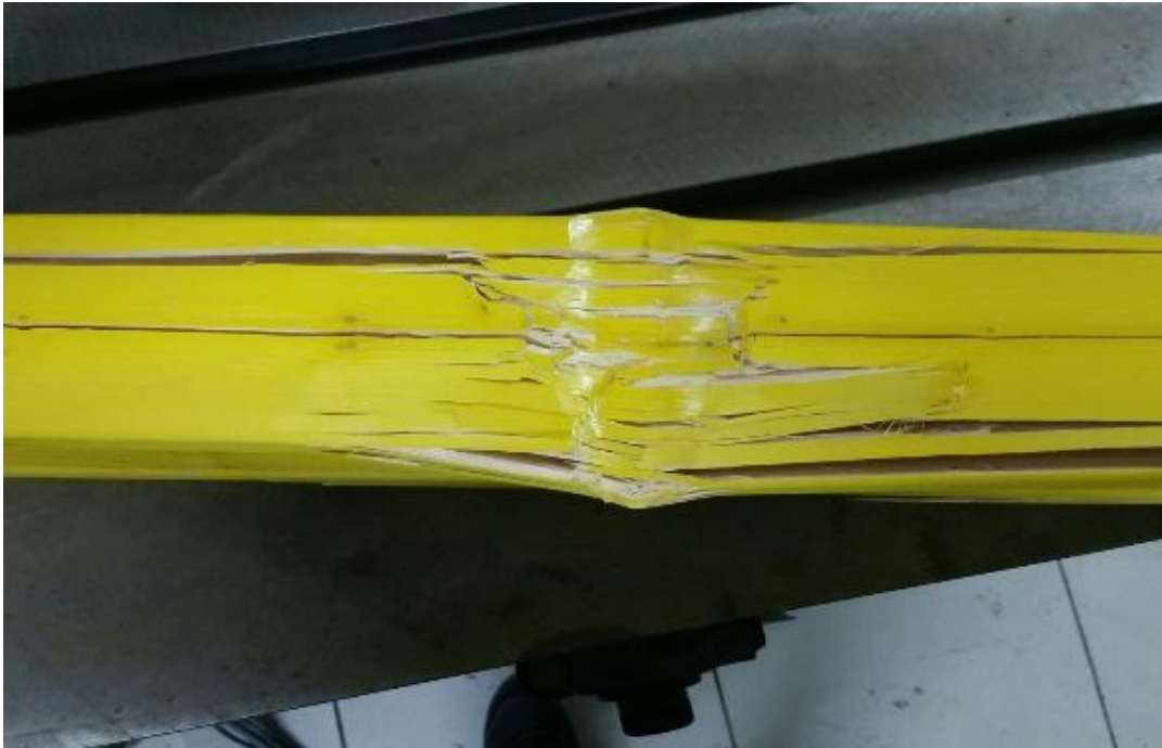
Resim 4.14. Deney elemanı-2 yorulma deneyi sonucunda ağır hasar alarak kırılmıştır
