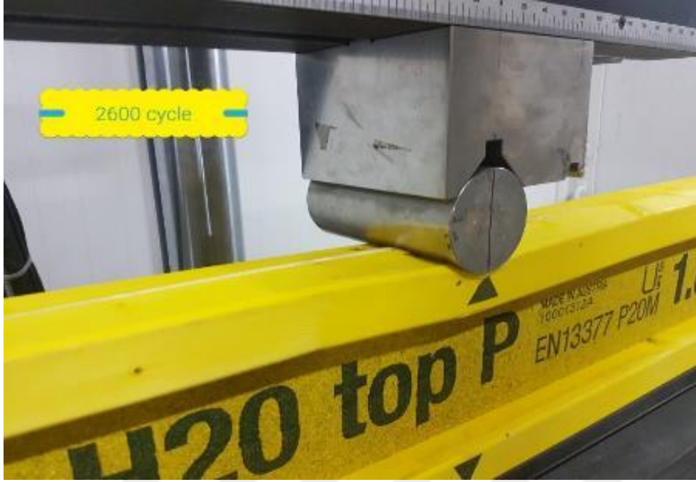
Resim 4.9. Deney elemanı-2 üzerinde 2600 tekrarda oluşan çatlaklar-2
