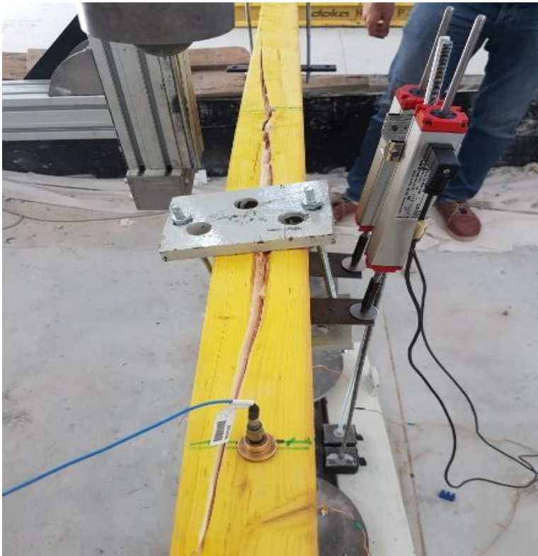
Resim 4.35. Deneysel yapılabirlikte bir ahşap kirişin ağırlık düşürme testi sonrası oluşan çatlakların detaylı görünümü.
