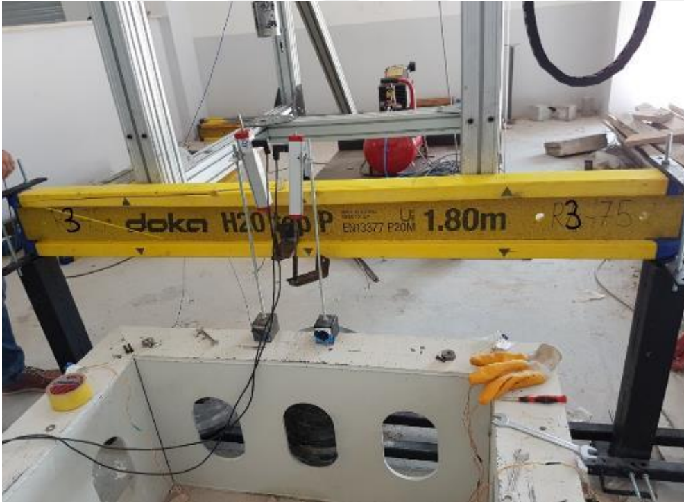
Resim 4.18. Deney elemanı-3 ağırlık düşürülmesi sonrasında oluşan hasar
