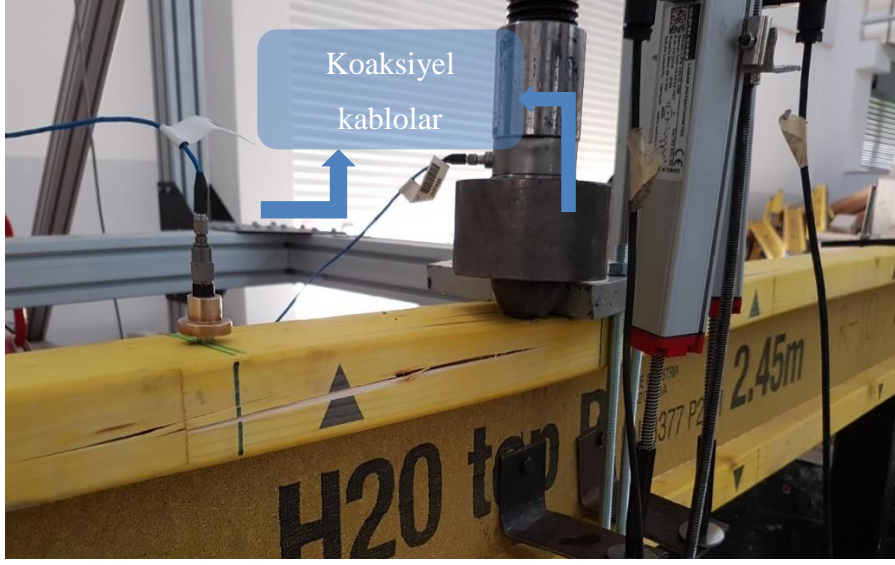
Resim 3.8. Koaksiyel kabloların çarpışma deneylerinde kullanımı
