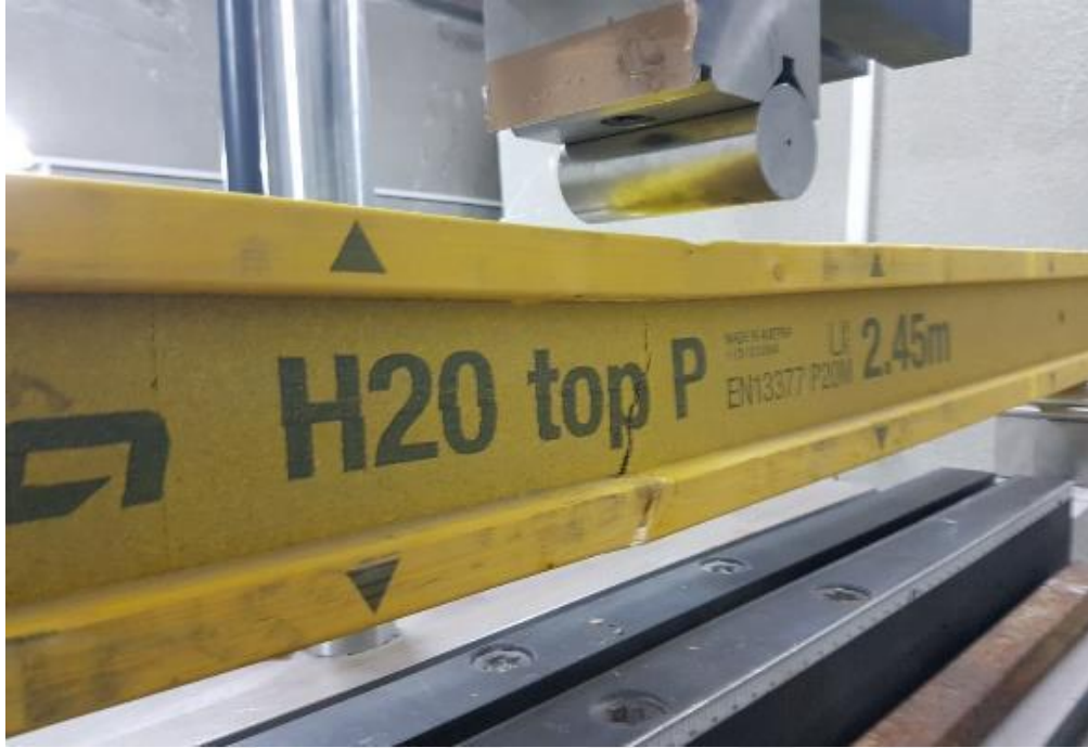
Resim 4.27. Deney elemanı-6 alt başlık ve gövde de kırılma
