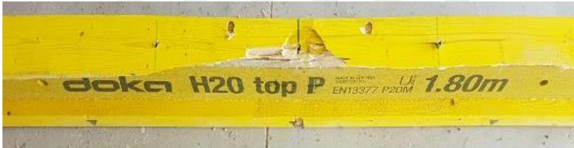
Resim 4.25. Deney elemanı-5 üzerinde oluşan hasar yan görünüşü
