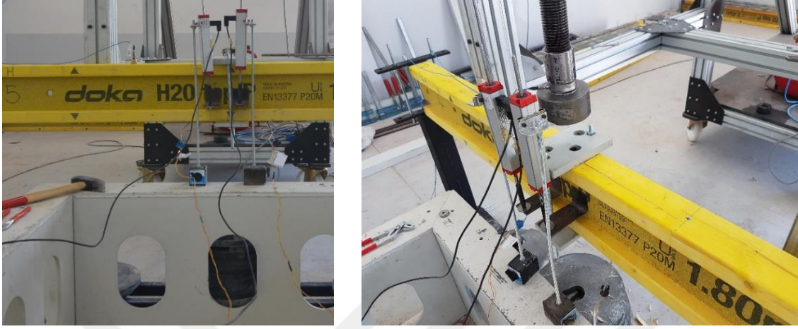
Resim 3.7. Potansiyometrik lineer cetvellerin (Lvd't) deney elemanları üzerine montajı
