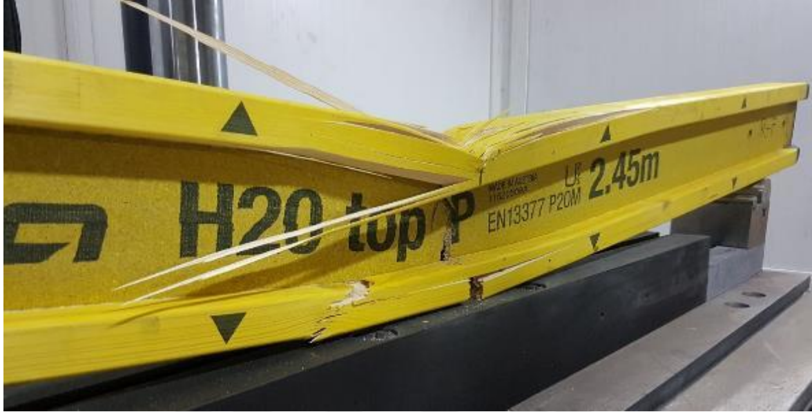
Resim 4.32. Deney elemanı-7 yorulma deneyi sonucunda ağır hasar oluşumu
