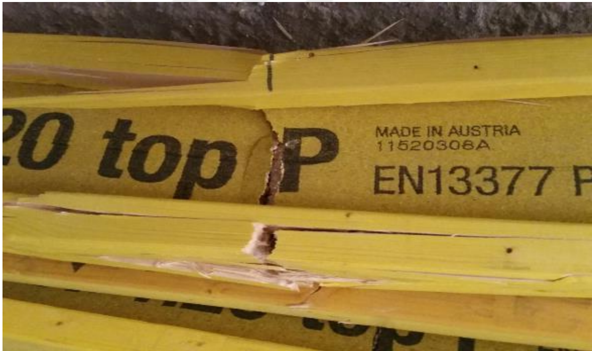
Resim 4.33. Deney elemanı-7 yorulma deneyi göçme oluşumu
