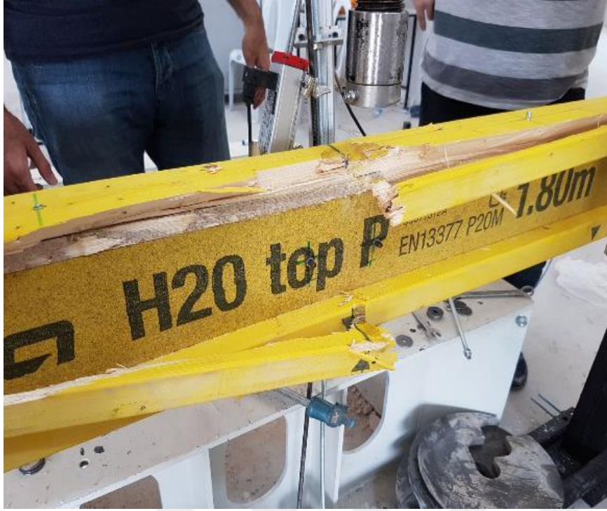
Resim 4.24. Deney elemanı-5 üzerinde çarpışma sonrası oluşan hasar
