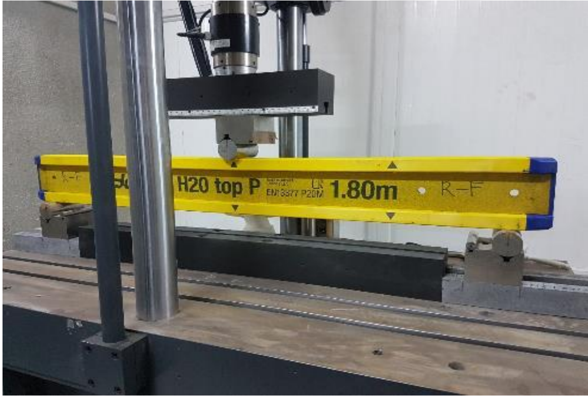
Resim 4.6. Deney elemanı-2 yorulma deneyi
