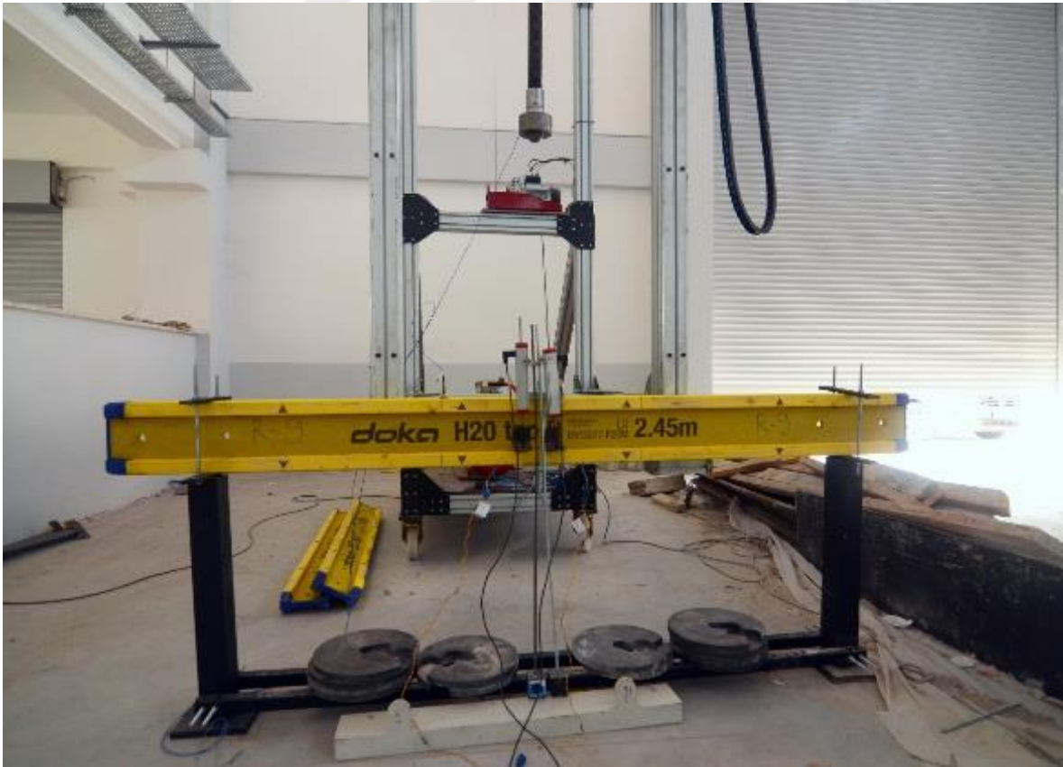
Resim 4.37. Deney elemanı-9 çarpışma test düzeneği
