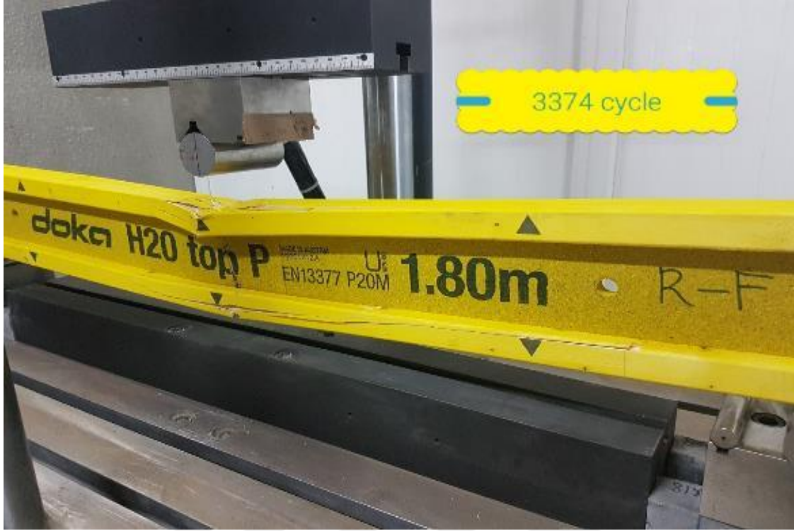
Resim 4.13. Deney elemanı-2 üzerinde 3373 tekrarda çökme oluşumu
