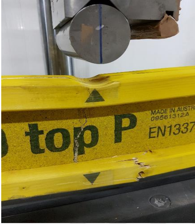
Resim 4.5. Deney elemanı-1 test sonucu ağır hasar oluşumu
