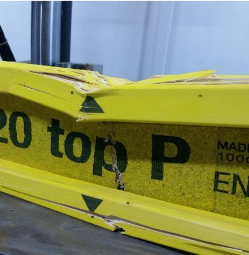
Resim 4.16. Deney elemanı-2 yorulma deneyi kiriş göçmesi
