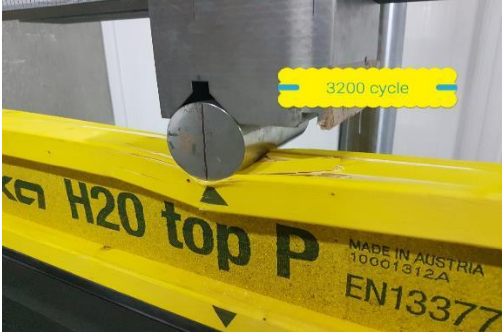
Resim 4.10. Deney elemanı-2 üst başlıkta 3200 tekrarda oluşan ezilme-1
