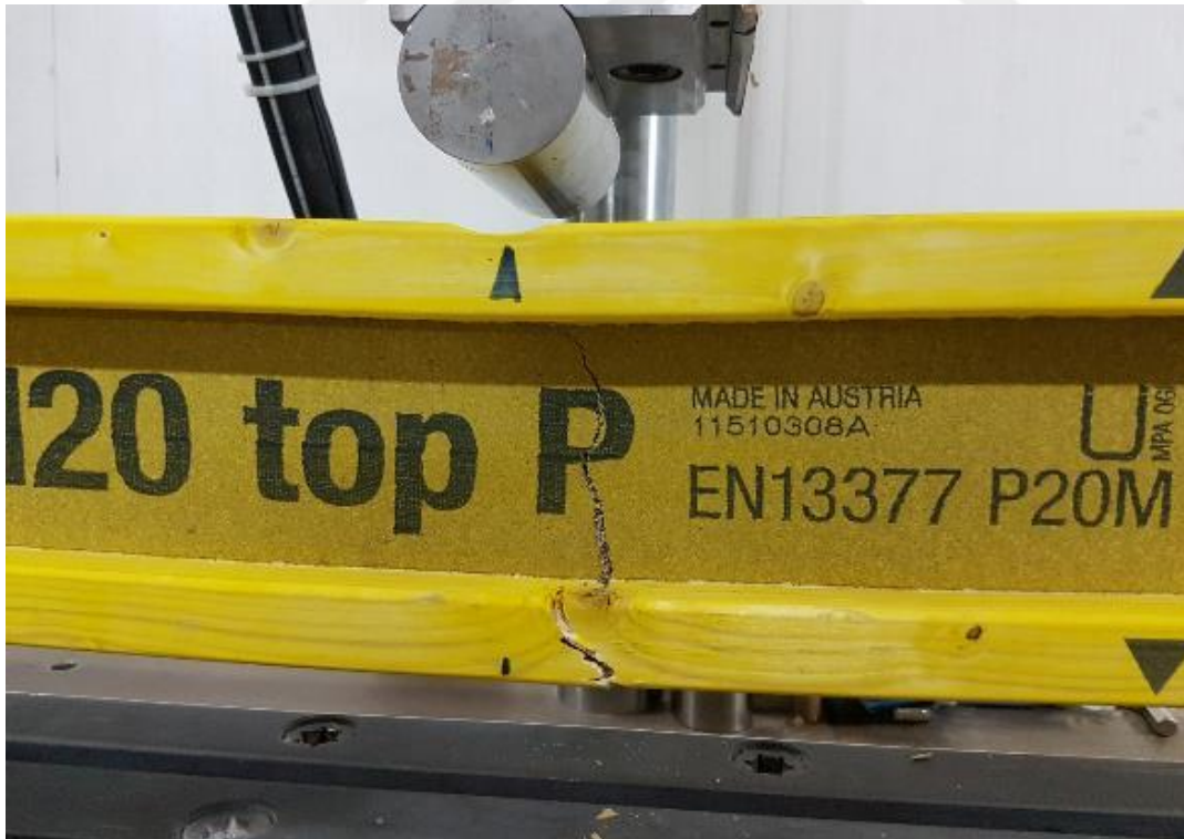
Resim 4.28. Deney elemanı-6 gövde ve alt başlık çatlak
