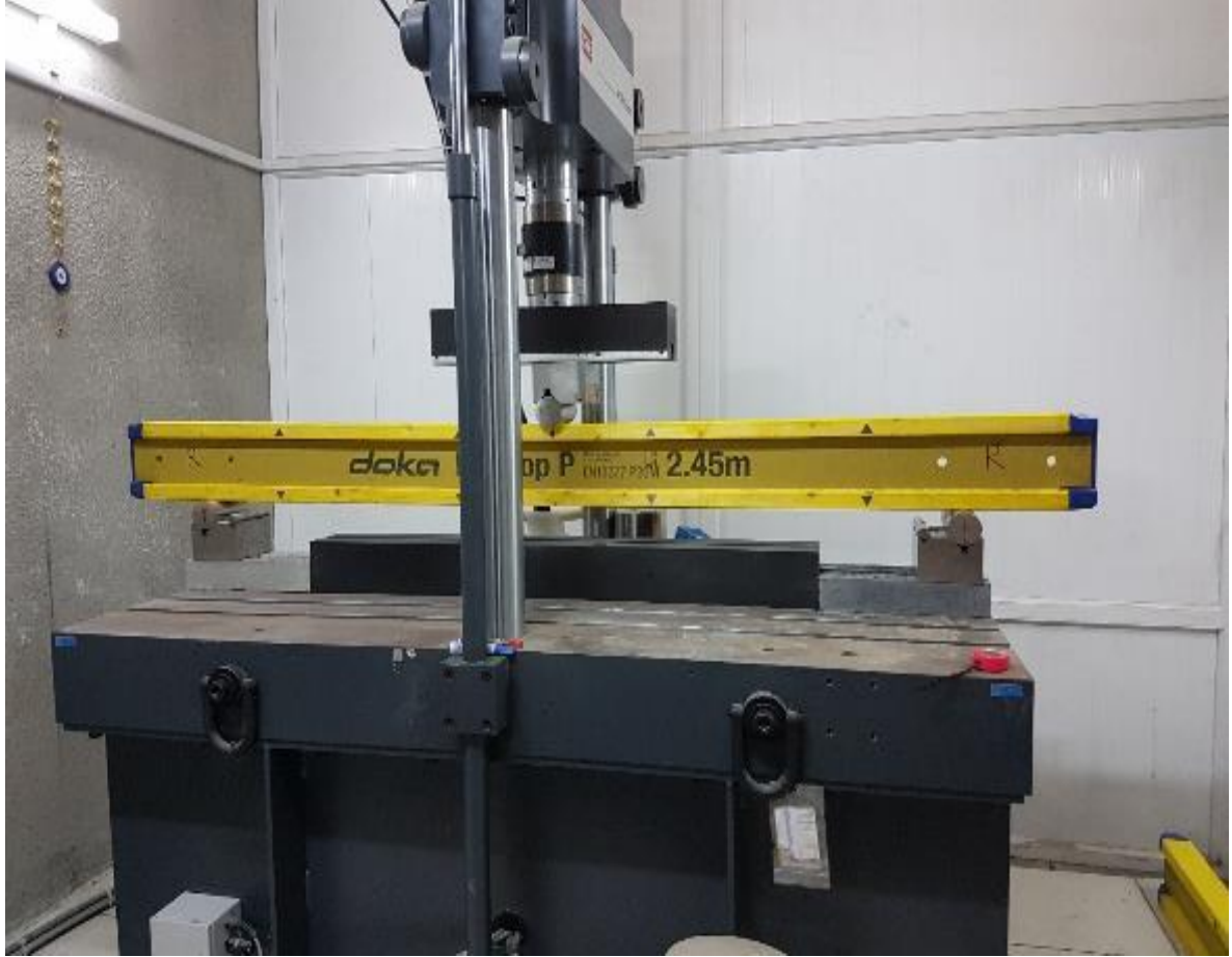
Resim 4.26. Deney elemanı-6 monotonik statik yükleme testi
