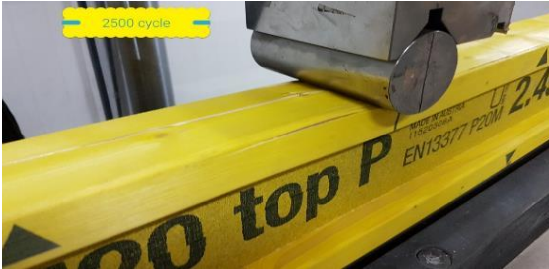
Resim 4.31. Deney elemanı-7 üzerinde 2500 tekrar hasar oluşumu
