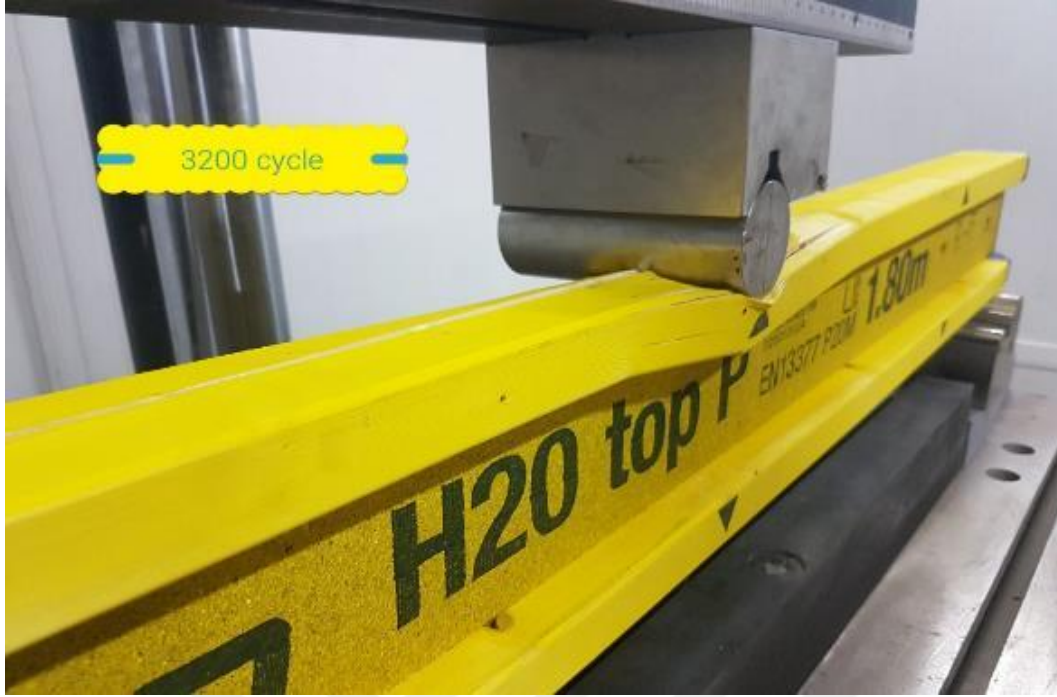
Resim 4.11. Deney elemanı-2 üst başlıkta 3200 tekrarda oluşan ezilme-2
