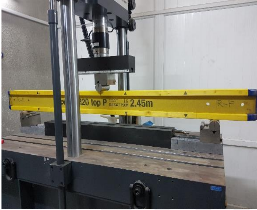
Resim 4.30. Deney elemanı-7 yorulma deney düzeneği
