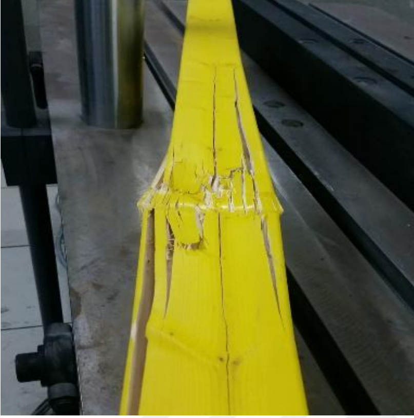
Resim 4.15. Deney elemanı-2 yorulma deneyi sonucunda üst başlık ezilmiştir
