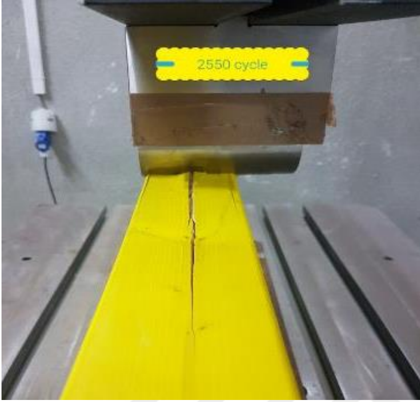
Resim 4.7. Deney elemanı-2 üzerinde 2550 tekrarda oluşan çatlaklar
