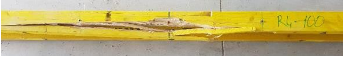
Resim 4.21. Deney elemanı-4 çarpma sonucu üst başlık hasarı-1
