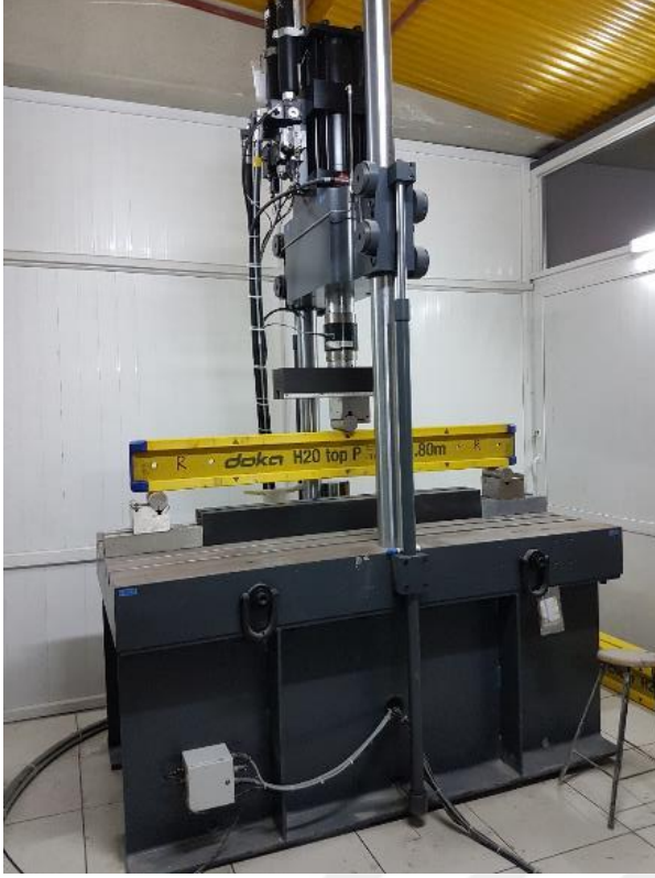
Resim 4.1. Deney elemanı-1 monotonik statik yükleme deneyi
