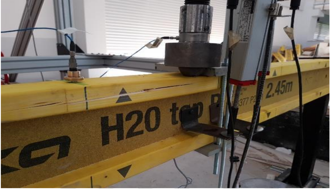
Resim 4.40. Deneysel yapıda hasar oluşumu-1
