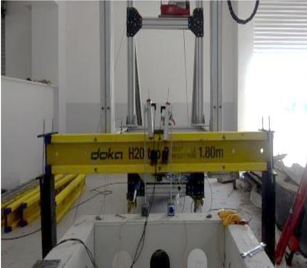
Resim 4.20. Deney elemanı-4 ağırlık düşürme deney düzeneği
