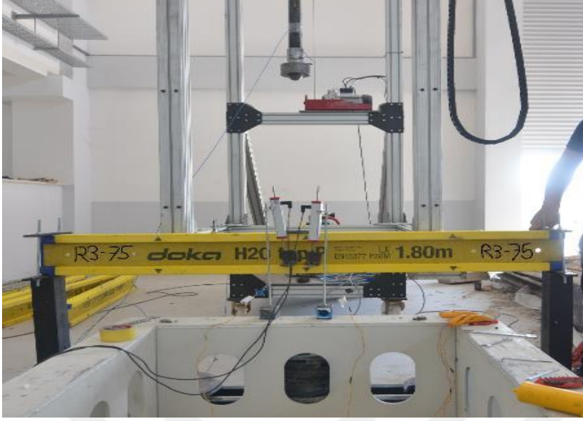
Resim 4.17. Deney elemanı-3 ağırlık düşürme deney düzeni
