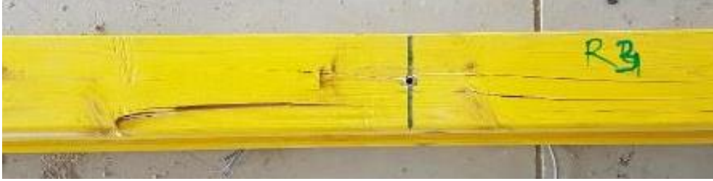
Resim 4.19. Deney elemanı-3 ivmeölçer takılması için açılan delikler
