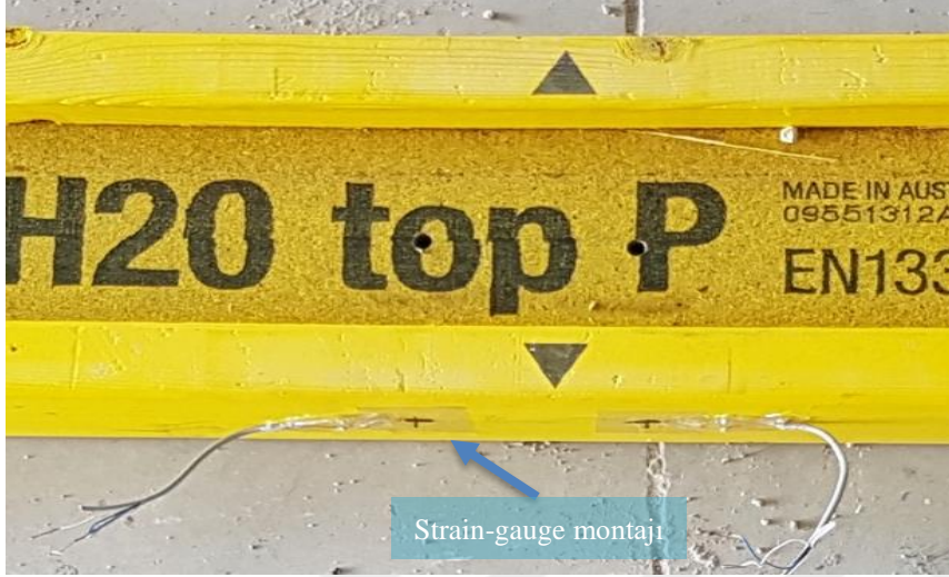
Resim 3.5. Strain-gauge'in deney elamanları üzerine montajı
