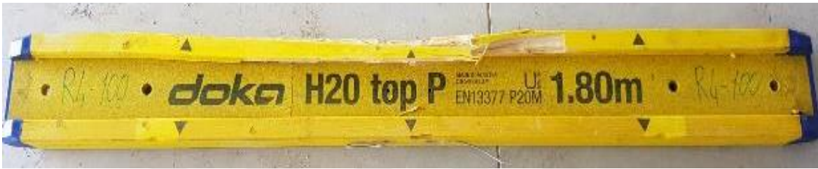
Resim 4.22. Deney elemanı-4 çarpma sonucu üst başlık hasarı-2
