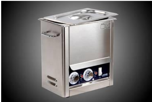
Resim 3.1. Ultrasonik banyo (DC4UT-PRO)
