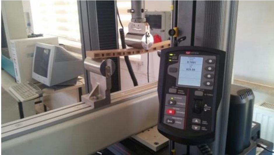
Resim 4.19. Eğilme direnci ve eğilmede elastikiyet modülü testinin yapılışı
