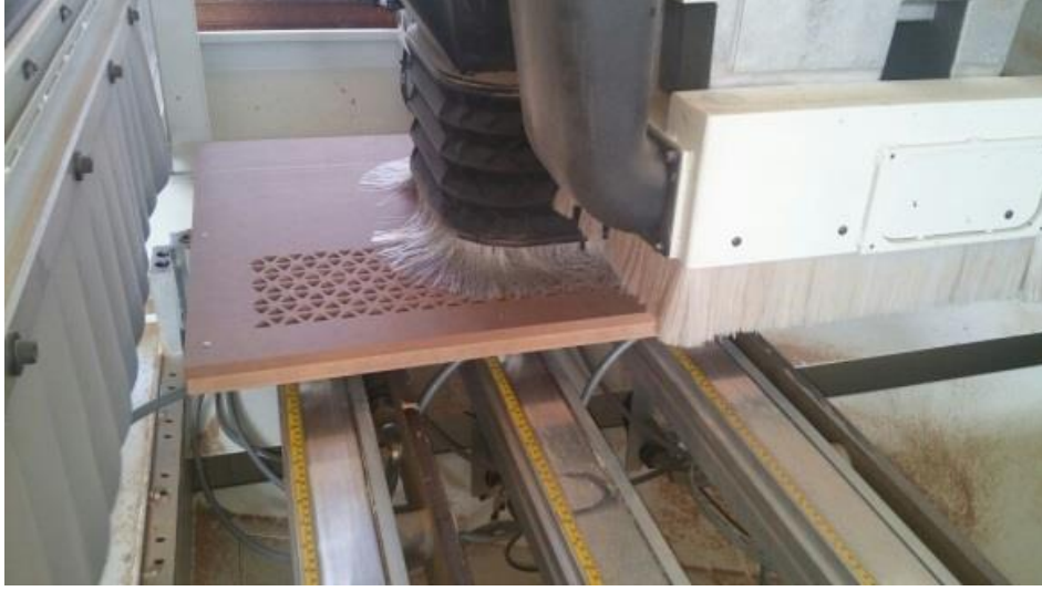
Resim 4.1. Deney numunesinin makinede işlenmesi
