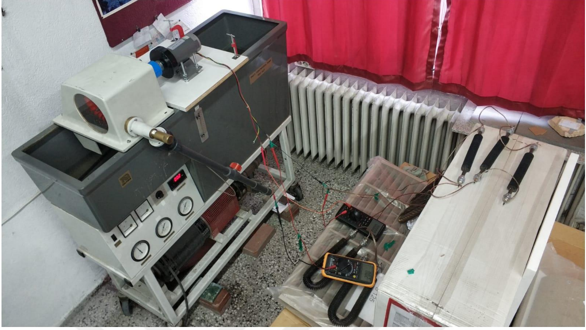
Resim 7.6. Çıkış gücü ölçümü için bağlanan voltmetre ve ampermetre
