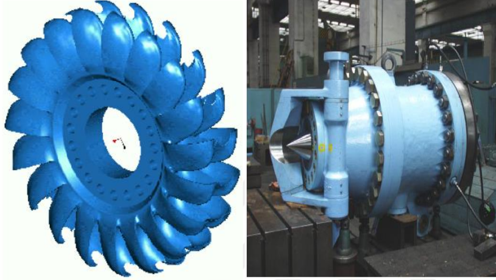
Şekil 3.8. Yeni çark tasarımı ve nozul yapısı (Vesely ve Varner, 2001)
