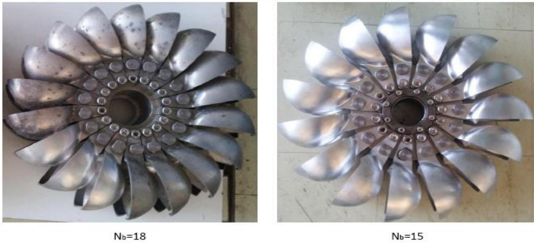
Şekil 3.14. Kepçe sayılarının azaltılması (Židonis ve Aggidis, 2016)
