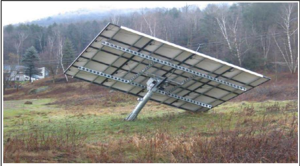
Şekil 1.1. Rüzgâr yüküne maruz kalan güneş takip sisteminde hasar oluşumu [1]
