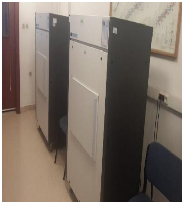
e) Sr-90 aktivitesinin belirlendiği sıvı sintilasyon spektrometresi
