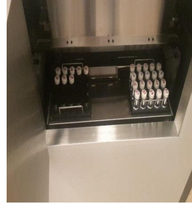
e) Sr-90 aktivitesinin belirlendiği sıvı sintilasyon spektrometresi
