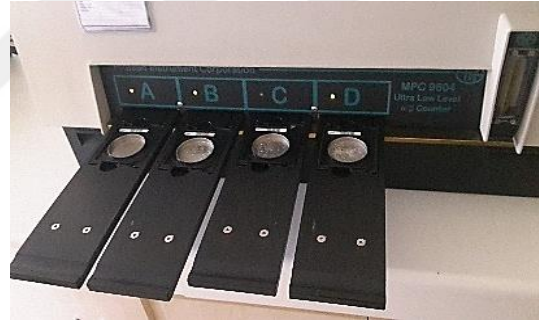
d) Pb-210 aktivitesinin belirlendiği toplam alfa/beta sayım sistemi
