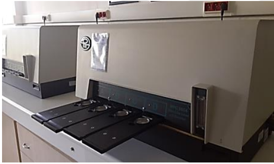
d) Pb-210 aktivitesinin belirlendiği toplam alfa/beta sayım sistemi
