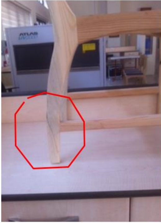
Resim 5.1.a. Çam sandalyelerin arka ayağındaki kırılma
