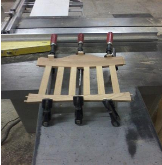
Resim 4.12. Eğmeçli arkalık elemanlarının montajı
