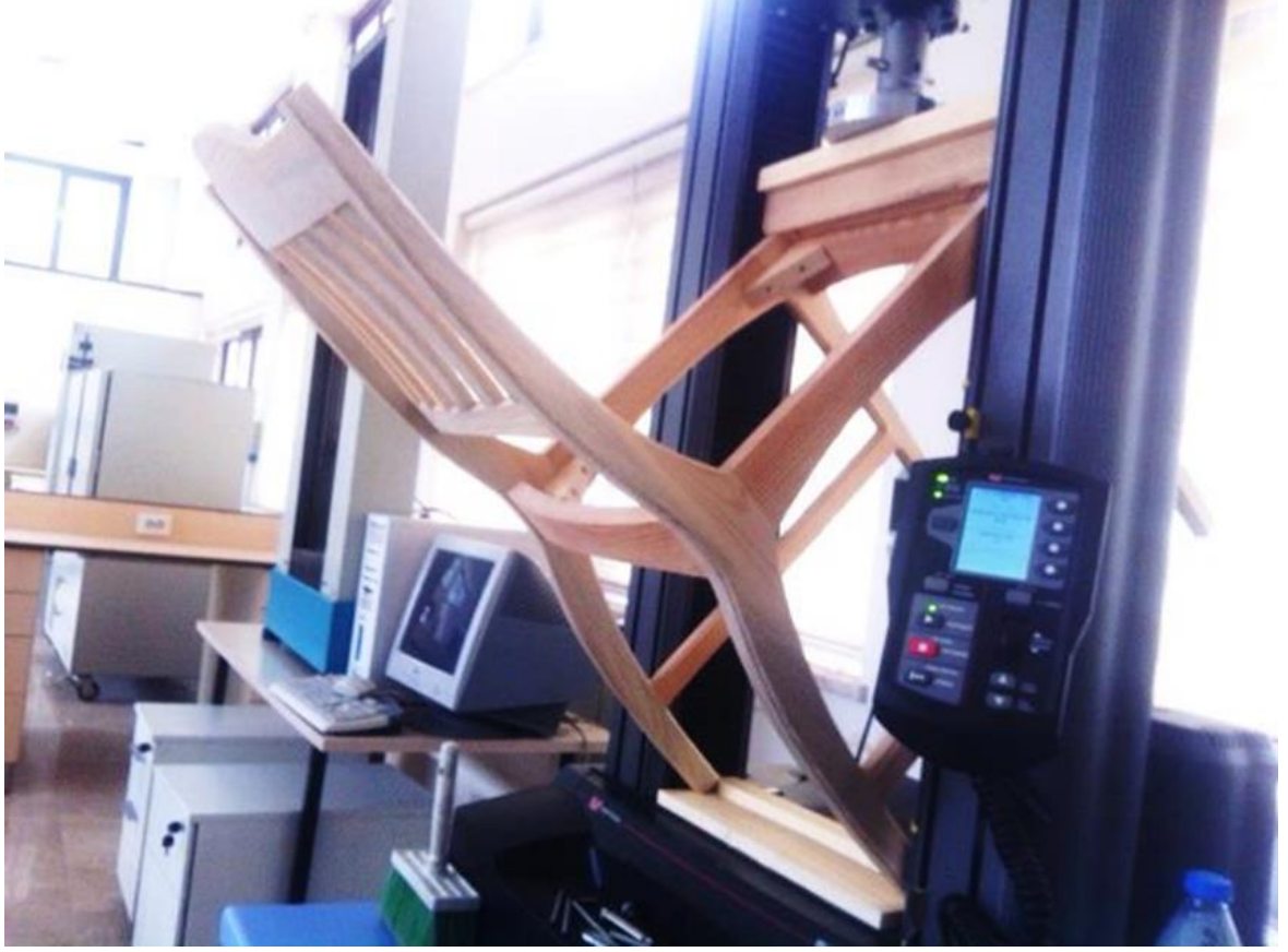
Resim 4.19. Sandalye diyagonal sağlamlık deneyi düzeneği
