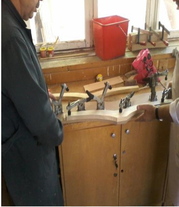
Resim 4.7. Sandalye arka ayak kaba ölçülü yüzeylerinin düzeltilmesi için kalıbın kullanılması
