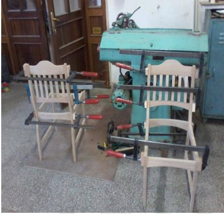
Resim 4.13. Sandalyenin işkence ile sıkıştırılması
