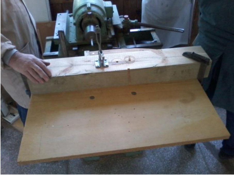
Resim 4.9. Ayaklara kalıp yardımı ile zıvana açılması
