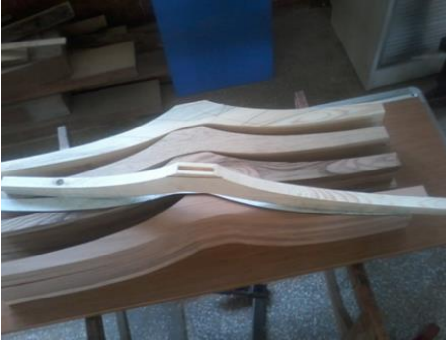
Resim 4.10. Ayaklara kalıp yardımı ile zıvana açılması
