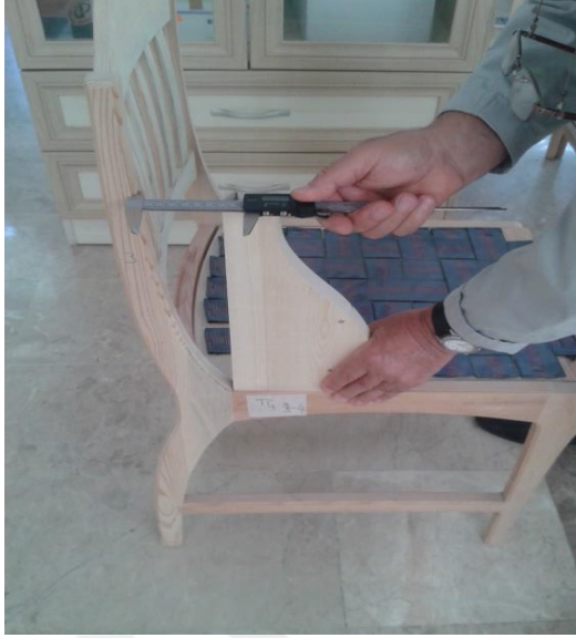
Resim 4.16. Sandalye arkalık sağlamlık testi öncesi ve sonrası zıvana açıklık ölçümü
