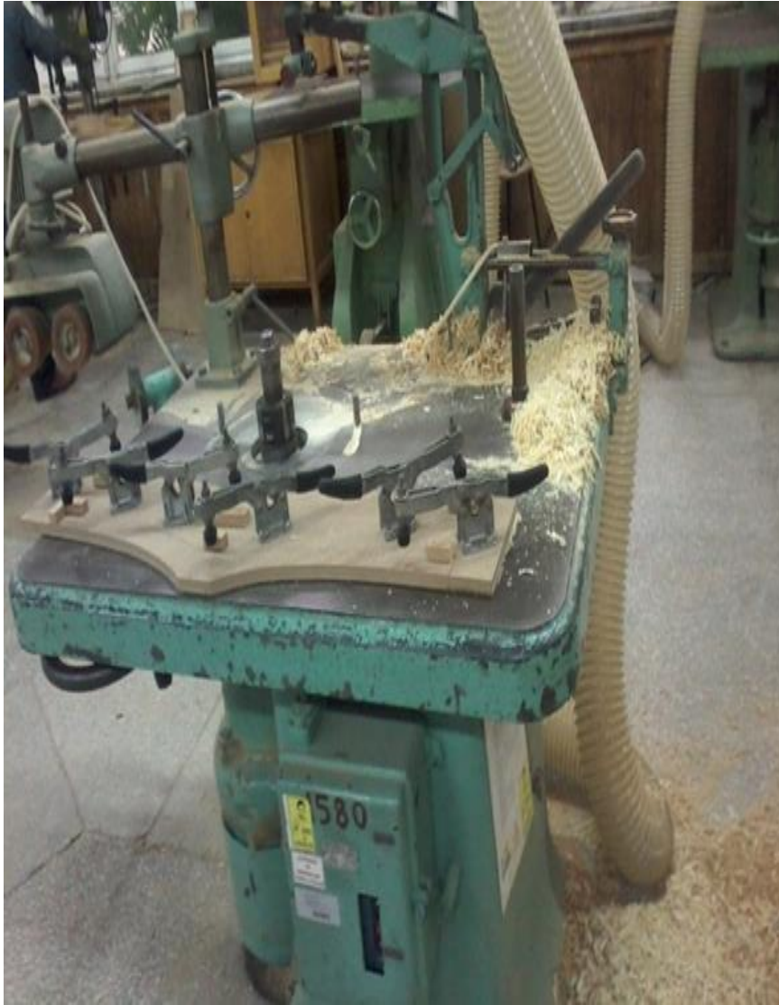
Resim 4.1. Arka ayak iç ve dış yüzeylerinin düzeltilmesi için hazırlanmış kalıp
