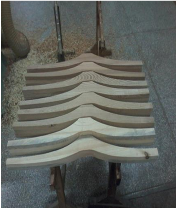
Resim 4.8. Yüzeyleri düzeltilmiş arka ayaklar
