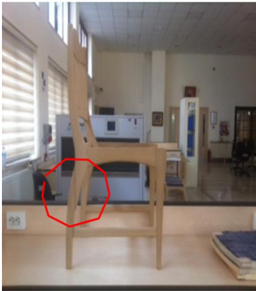
Resim 5.1.b. Meşe sandalyelerin arka ayağındaki kırılma
