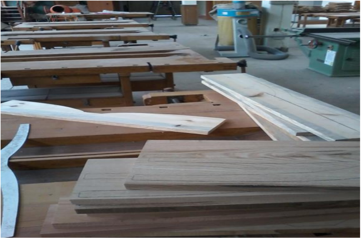
Resim 4.4. Arka ayak taslaklarının kesilerek şekillendirilmesi
