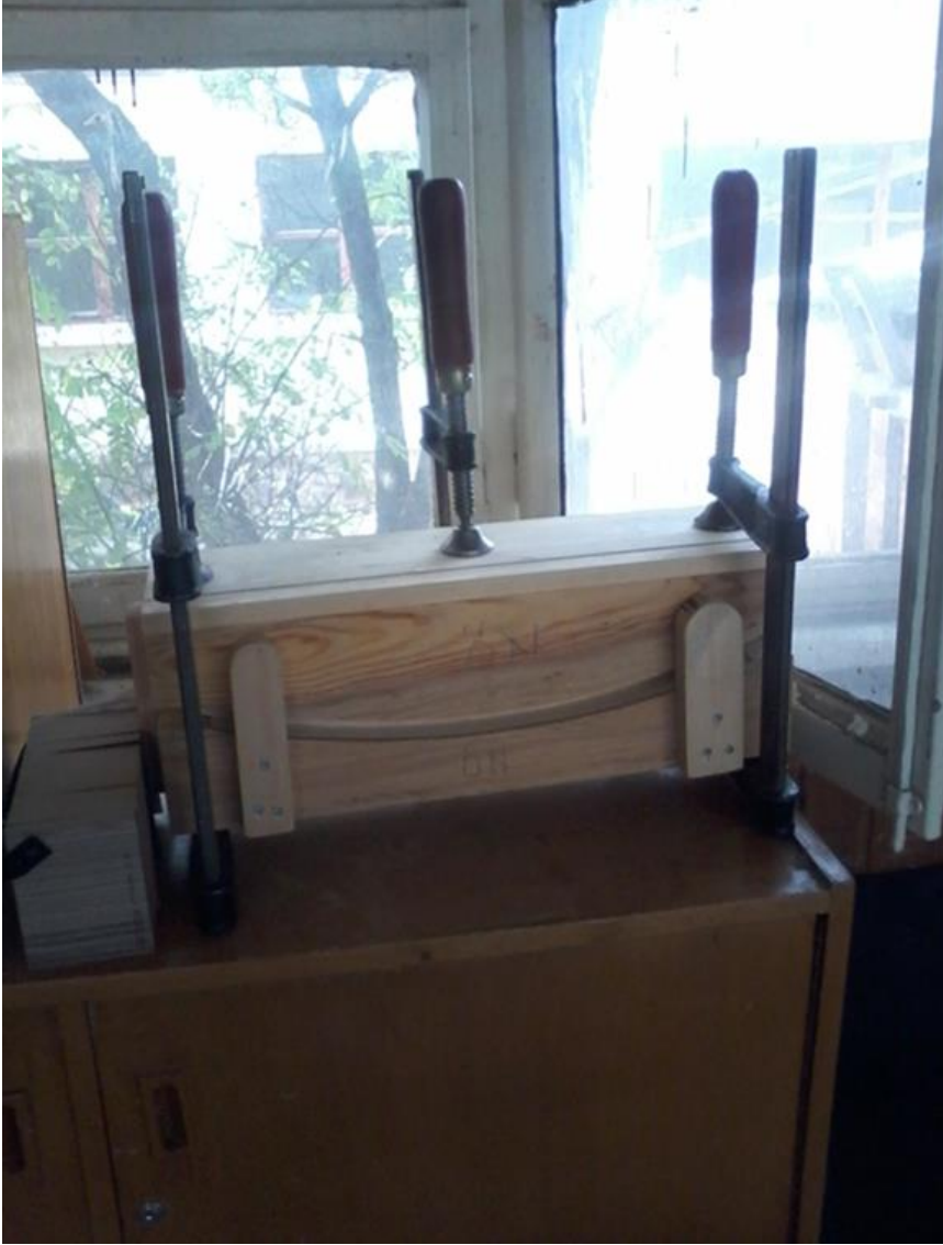
Resim 4.2. Eğmeçli elemanlara eğme işlemi yapmak için hazırlanmış kalıp
