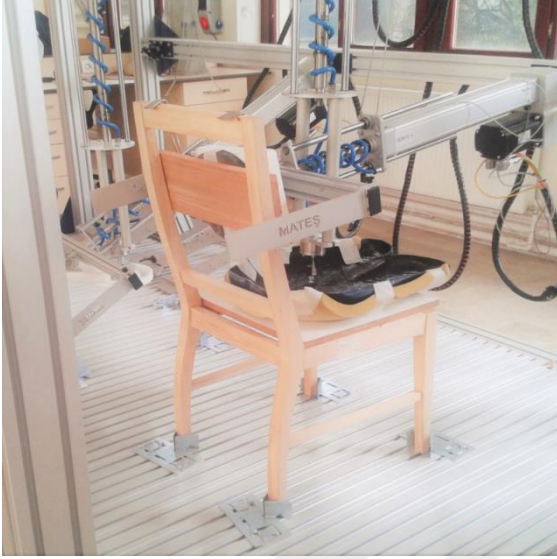
Resim 4.17. Sandalye arkalık sağlamlık testi uygulaması
