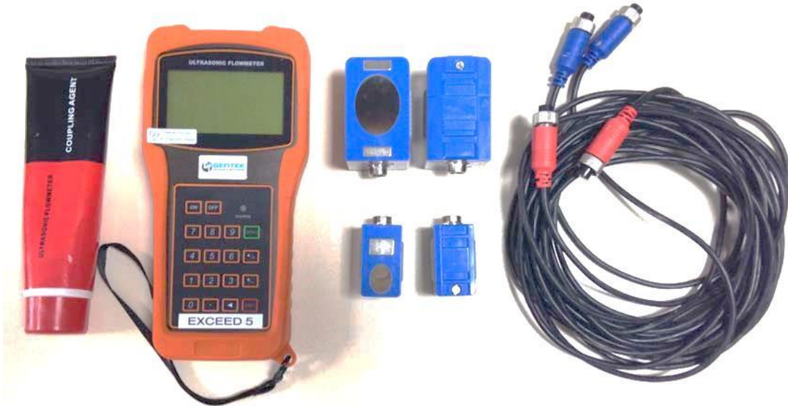
Şekil 3.1. TFM110-P modeli portatif ultrasonik debimetre
