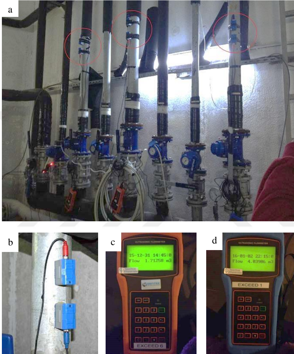
Şekil 3.2. Doğrudan su tüketimi belirlenmesi amacıyla 5 yıldızlı bir konaklama tesisinde yapılan ölçümler ait fotoğraflar; a) Ölçüm yapılan borulara ait genel fotoğraf; b) Transdüser; c) Odalar sıcak su borusuna ait bir ölçüm sonucu (31.12.2015, 14:45); d) Odalar soğuk su borusuna ait bir ölçüm sonucu (02.01.2016, 22:15)
