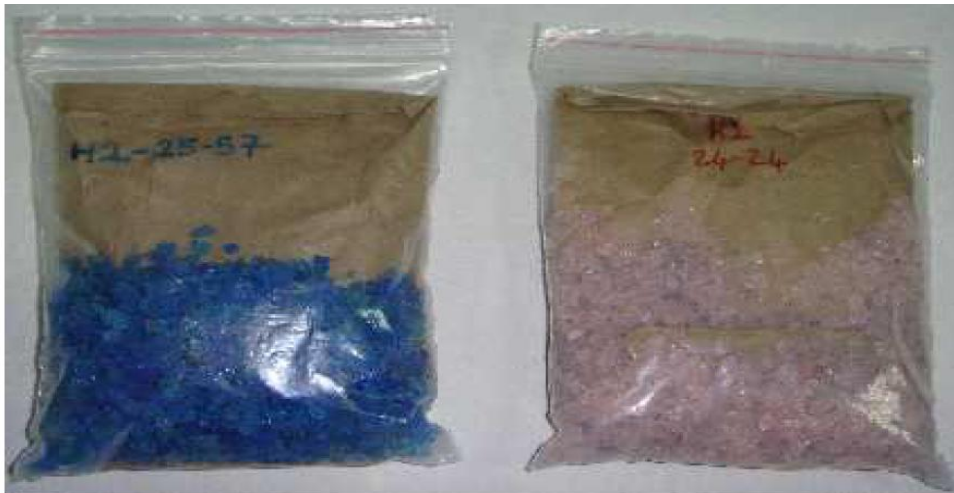
Şekil 3.4. Nemi alınarak kilitli poşete yerleştirilmiş silika jel ile içerisinde örnek bulunan ağzı kapatılmış kese kağıdı (solda); örneğin suyunu çekmek suretiyle nemlenerek pembeleşmiş silika jel (sağda)
