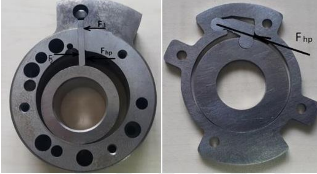
Resim 5.2. Klasik palet sistemi ve menteşe palet sistemi üzerine etki eden kuvvetler
