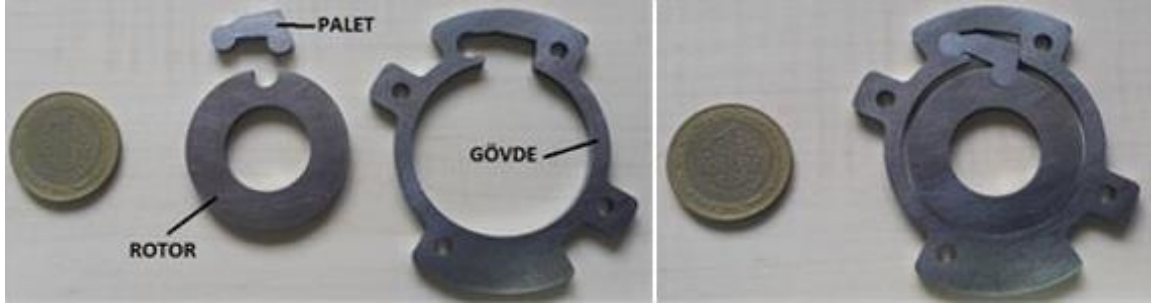
Resim 5.5. AISI H13 çeliğinden üretilen kompresör parçaları
