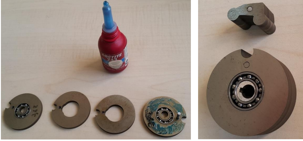
Resim 5.7. Üniteler arası kaçakları engellemek amaçlı yapıştırma işlemi
