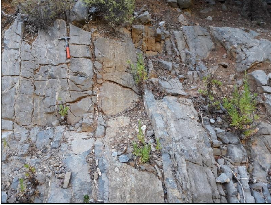
Şekil 4.7. Yüglüktepe formasyonunda gözlenen kalın tabakalı ve bol çatlaklı kireçtaşları (Bakış yönü: KB)
