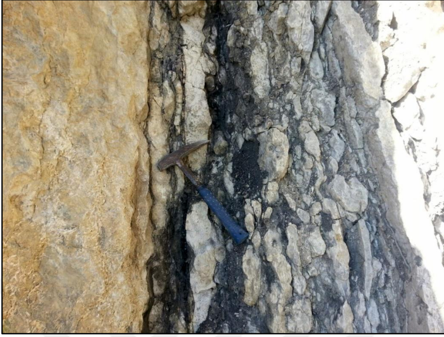
Şekil 4.3. Pamucak formasyonu tavan kısmında görülen nodüler katmalı kireçtaşları ve siyah çamurtaşı düzeyleri
