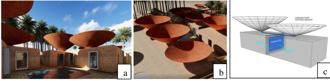
Şekil 2.31. (a ve b) Concave roof genel görünümü, (c) Yağmur suyu toplama sistemi şematik gösterimi (URL-24)
