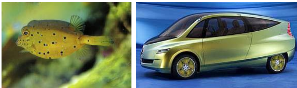
Şekil 2.3. Kutu balığından esinlenerek tasarlanan biyonik otomobil (Volstad ve Boks, 2008)
