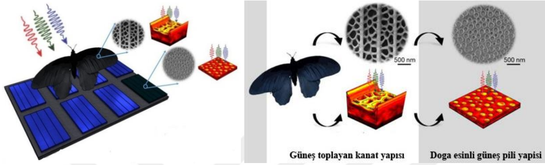
Şekil 2.4. Gül kelebeğinin kanadından esinlenerek geliştirilen güneş pili (URL-1)
