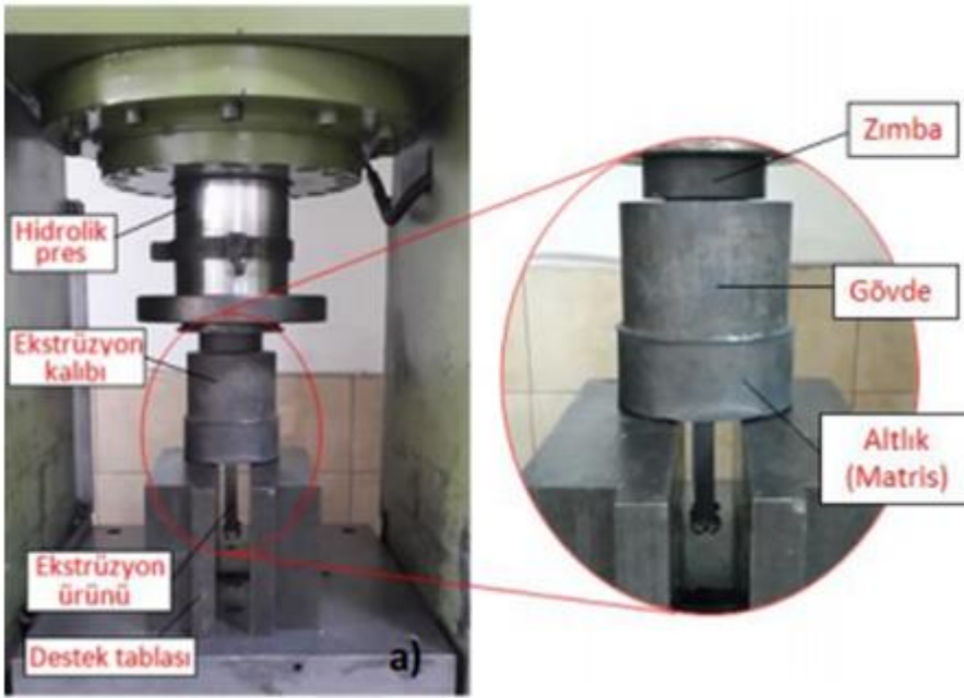
Resim 3.4. Ekstrüzyon kalıbı ve hidrolik pres
