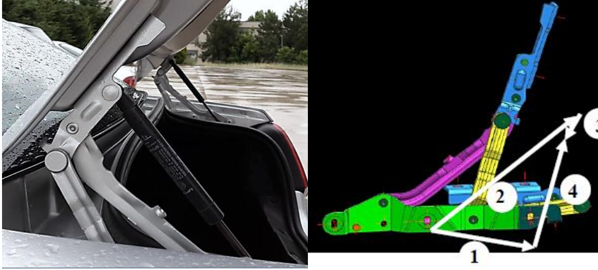
Şekil 2.12. Gazlı pistonlu bagaj kapağı açma-kapama mekanizması [10]
