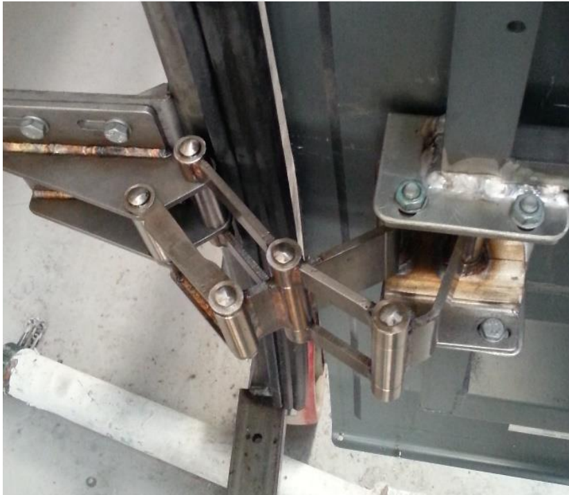
Şekil 4.35. Otobüs bagaj kapı çerçevesine yeni menteşe mekanizmanın montajı
