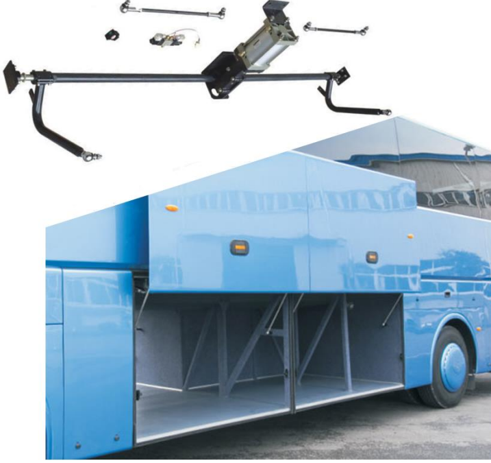
Şekil 2.10. Pnömatik tahrikli bagaj kapak sistemi [7]
