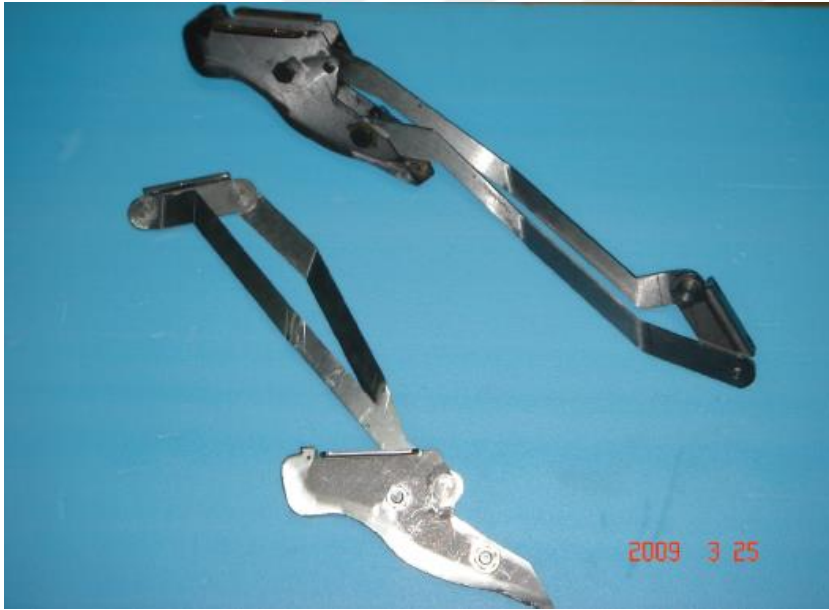
Şekil 2.15. Önerilen dört-çubuk mekanizması [13]
