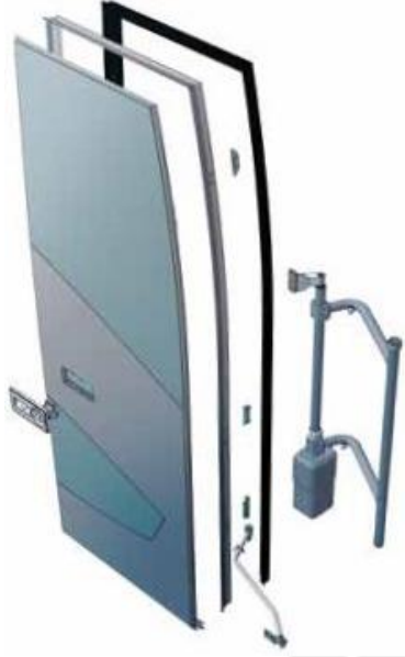
Şekil 2.9. Pnömatik tahrikli dışa salınımlı kapı sistemi [7]
