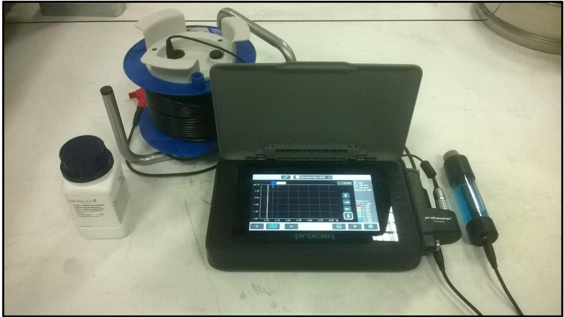
Şekil 3.6. Korozyon ölçüm düzeneği genel görünümü
