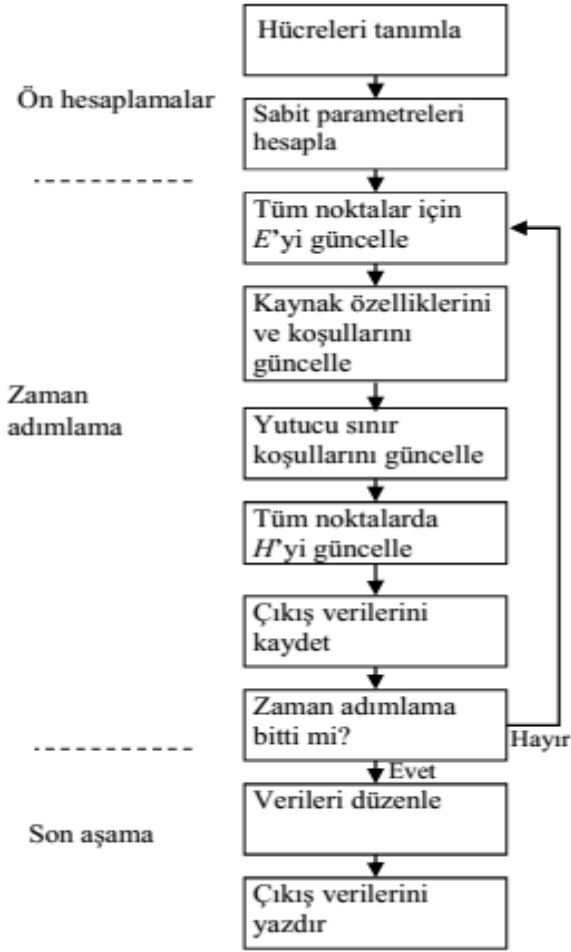
Şekil 3.32. TM Modu ZDSF Akış Şeması
