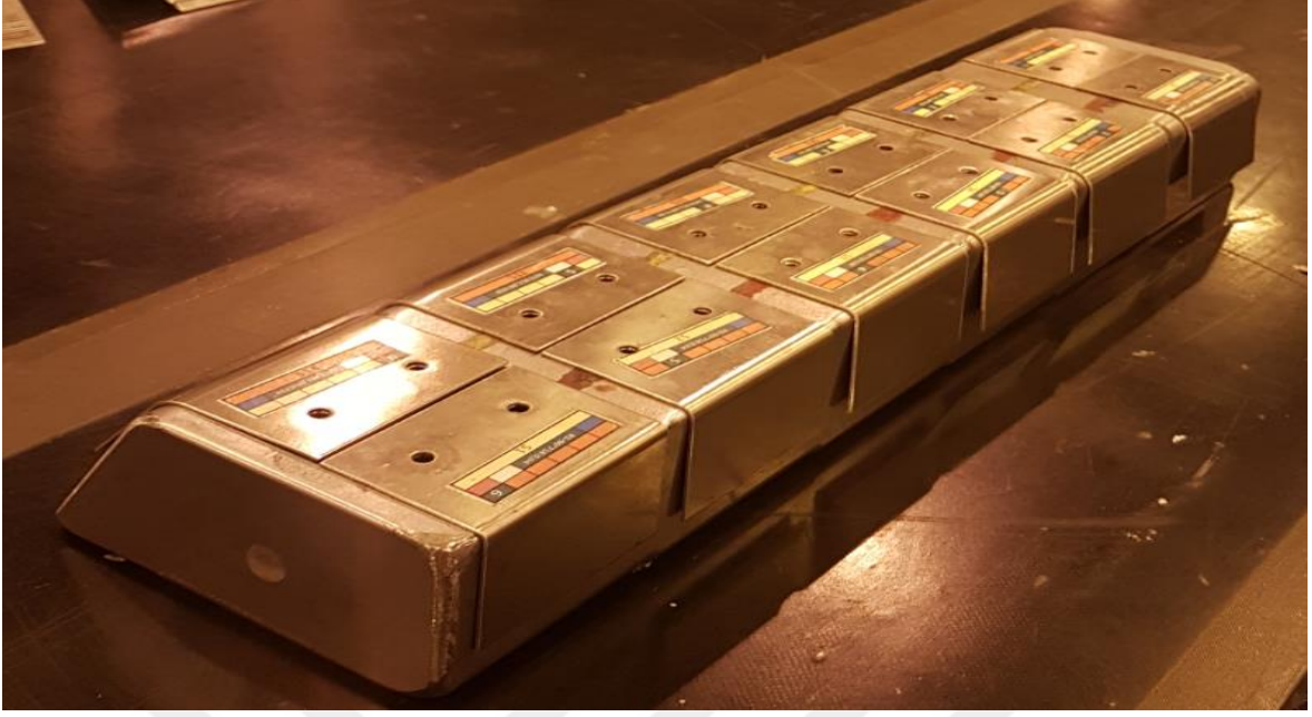
Resim 5.1. Test kalıbı üzerinde numunelerle birlikte
