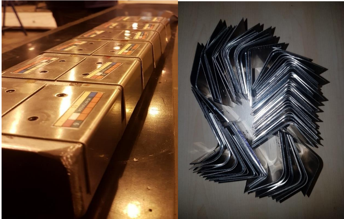
Resim 5.4. Numuneler büküm sonrasında
