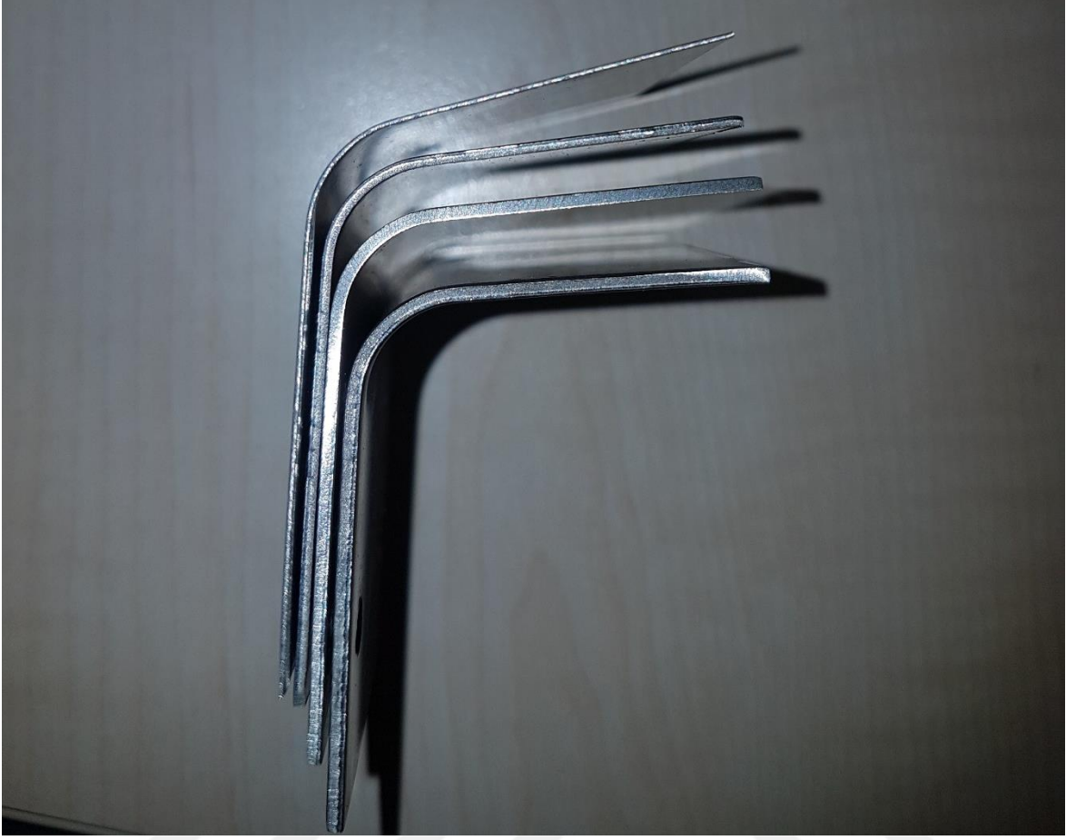
Resim 8.1. Büküm sonrası geri esneme davranışı
