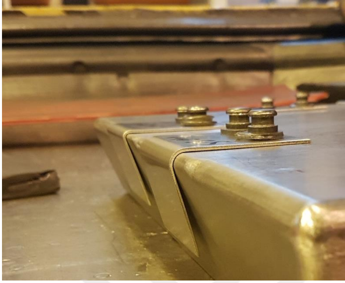
Resim 5.3. Numuneler büküm sonrasında
