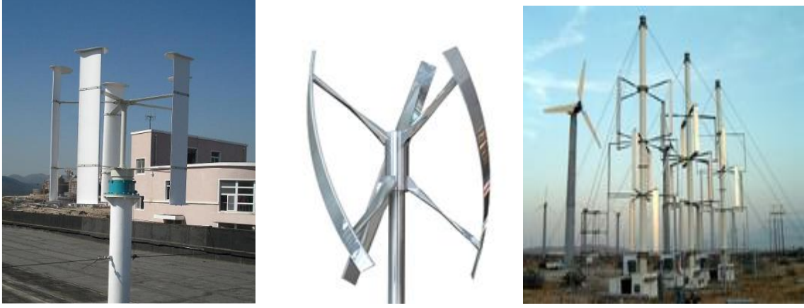
Resim 1.3. Dikey eksen türbinlerine örnekler (Richards ve diğerleri, 2011)
