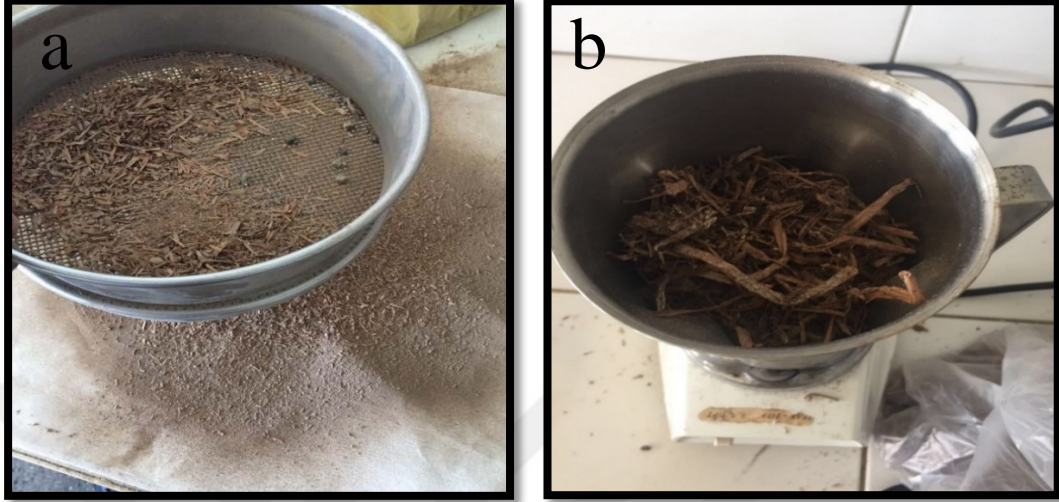
Şekil 3.8. a) Atık mantar kompostu eleme işleminden genel görünüm b) Atık mantar kompostunun mikserle ince hale getirilmesinden genel görünüm
