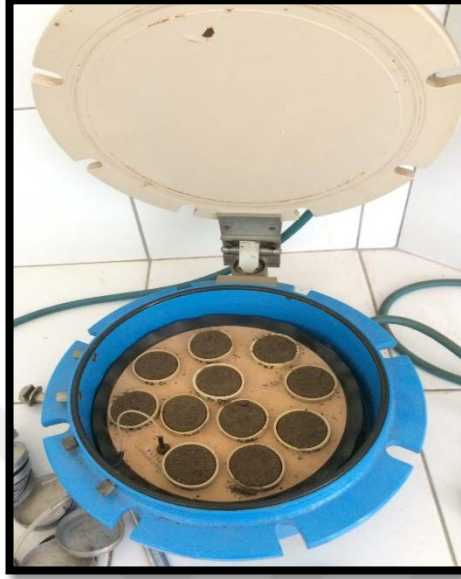
Şekil 3.12. Toprakların tarla kapasitesi ve solma noktası analizlerinin yapıldığı basınçlı levha ve basınçlı membran aleti.
