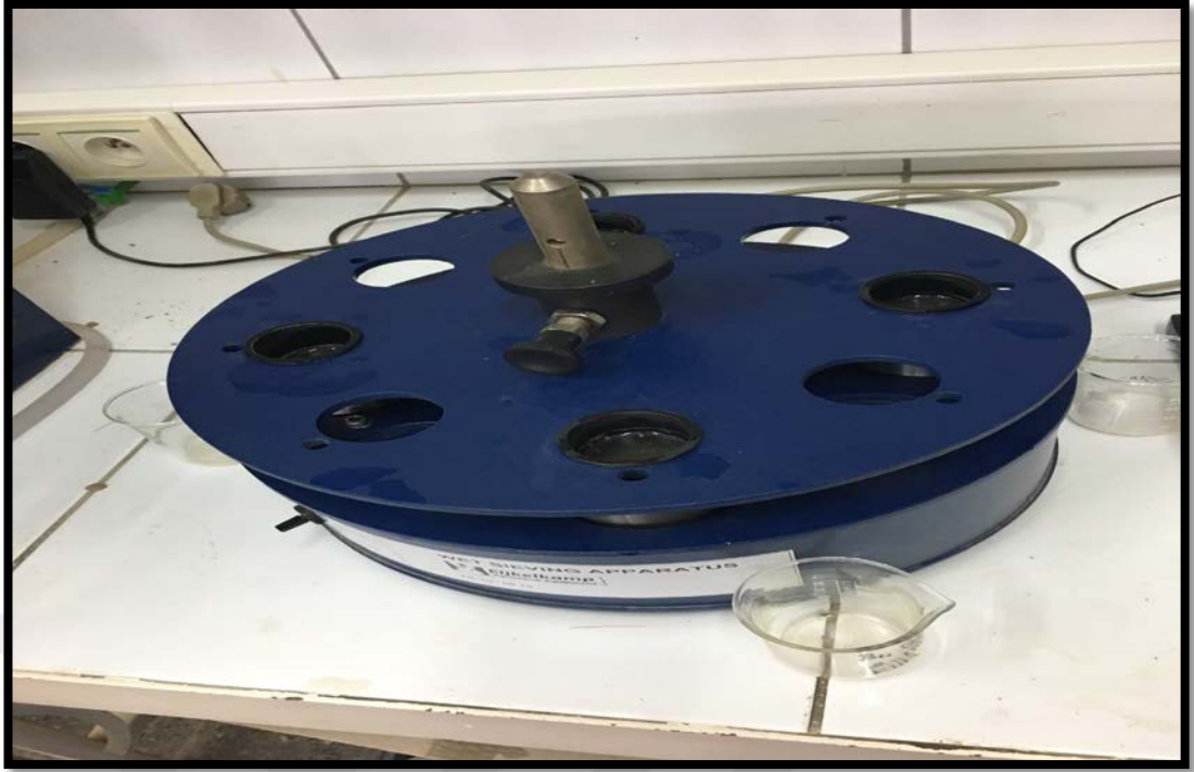
Şekil 3.15. Agregat stabilitesi analizi için örnek elemesinde kullanılan Yoder ıslak eleme aletini görünümü
