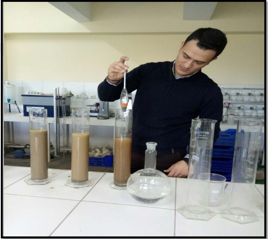
Şekil 3.11. Başlangıç toprağının tekstürünün Bouyoucos hidrometre yöntemine göre belirlenmesinden bir görünüm
