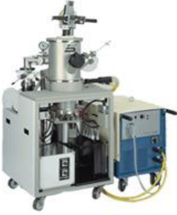
Resim 5.1. Ark ergitme sistemi ve numune haznesi
