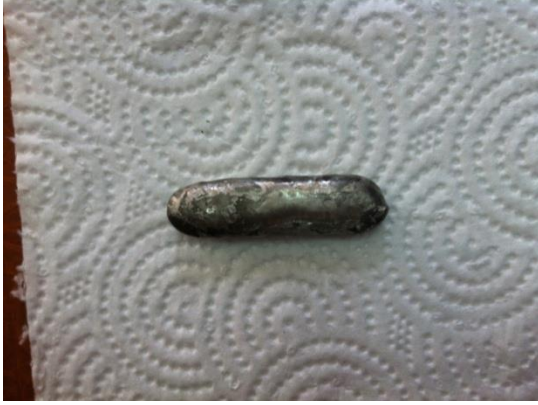
Resim 5.2. İngot halindeki Ni 50 Mn 39 Sn 11 alaşımı
