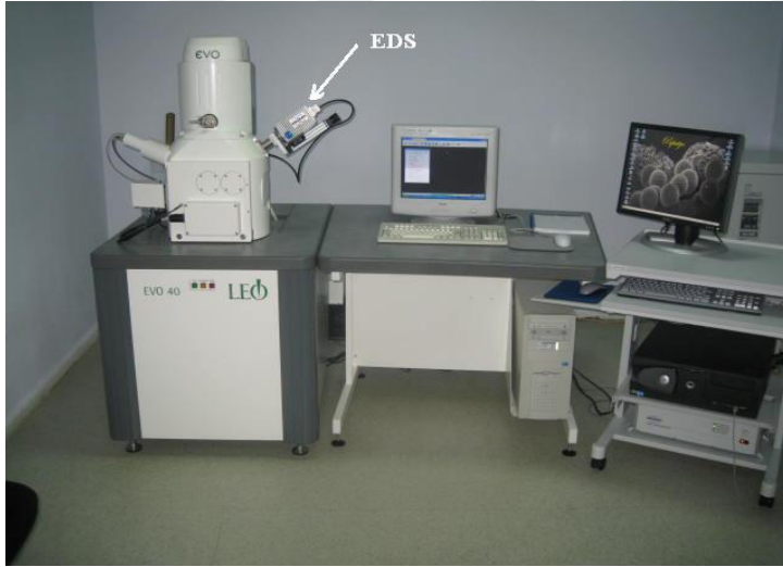
Resim 5.4. LEO-EVO 40 taramalı elektron mikroskobu ve Bruker-125 eV Energy Dispersive X-Ray Spectroskopy ünitesi
