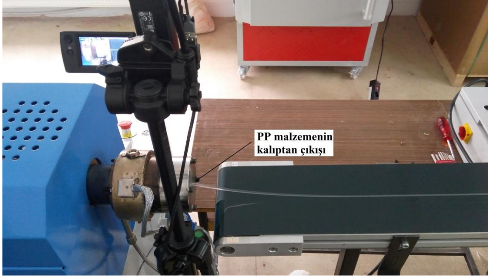
Şekil 6.15. PP eriyiğinin kalıp nozulundan akması
