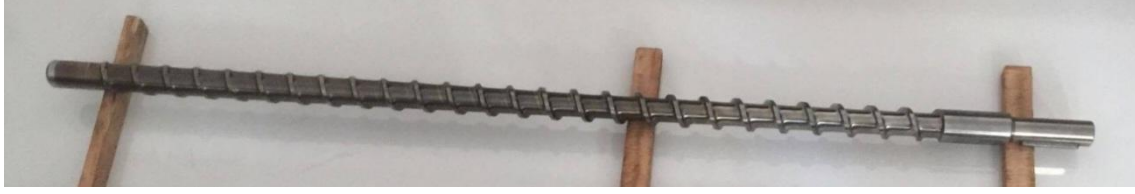
Şekil 6.3. Makinede kullanılan ekstrüder vida
