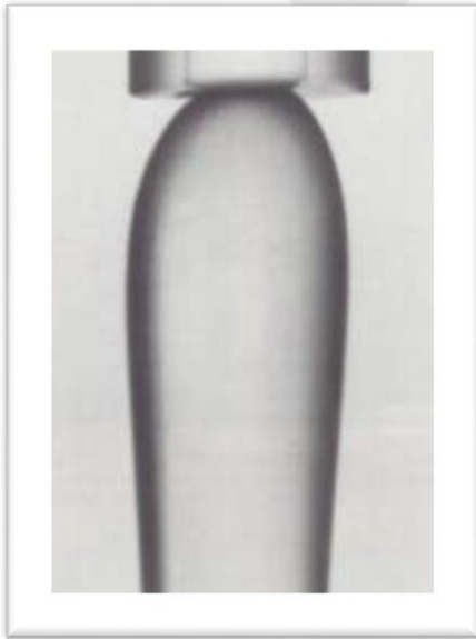
Şekil 4.1. Dairesel kesit için şişme [9]
