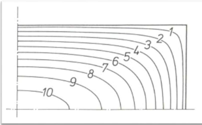
Şekil 4.3. Çeyrek dikdörtgen kesit için hız alanı gösterimi [9]
