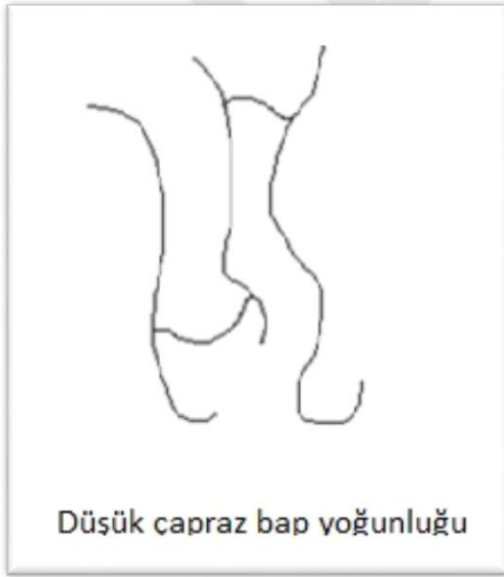
Şekil 2.5. Elastomerlerin molekül yapısı [3]
