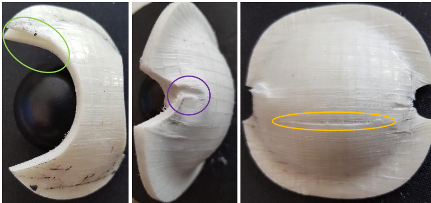
Resim 4.10. Çekme derinliğinin fazla olması durumunda PA6-60, PP-70 ve PA6-70 kompozit levhaların deformasyonları
