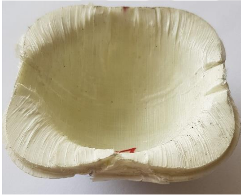
Resim 4.4. Derinlik 30 mm iken PP-60 kompozit levhanın delaminasyon durumu
