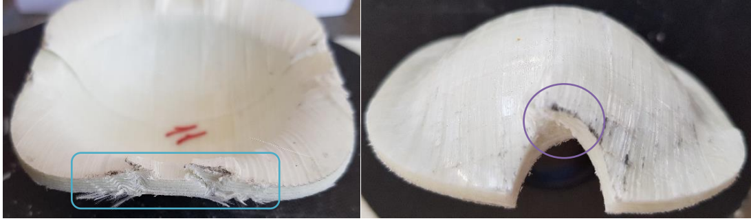
Resim 4.8. 0,4 MPa tutma basıncıyla derin çekilmiş PP-70 ve PA6-70 numuneleri
