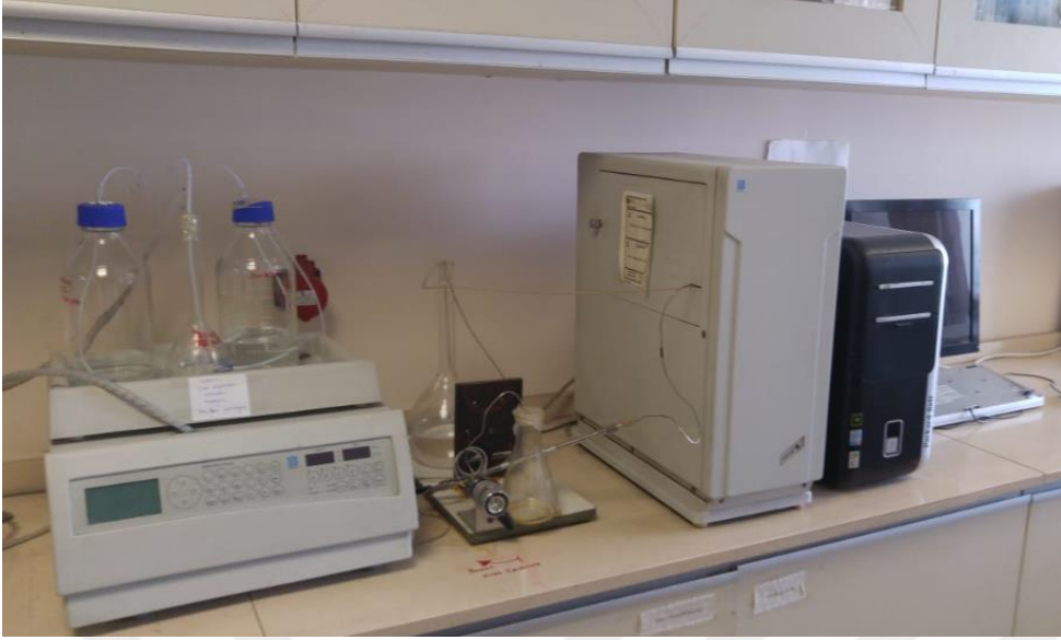
Resim 6.3. UV dedektörlü HPLC cihazı ve bilgisayar
