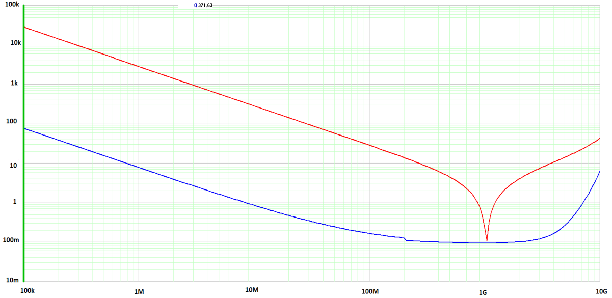
Şekil 5.2. Kondansatörün frekans-ESR grafiği (Hz- \Omega eksenleri)
