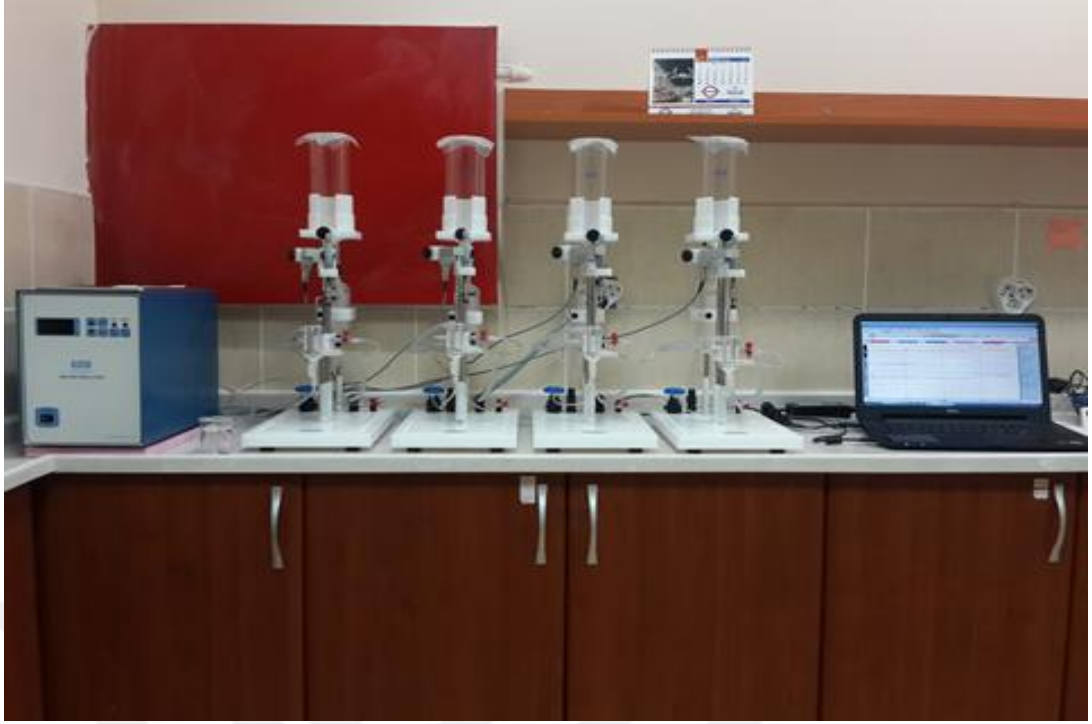
Şekil 3.1. İzole organ banyosu ve kayıt sistemi.
