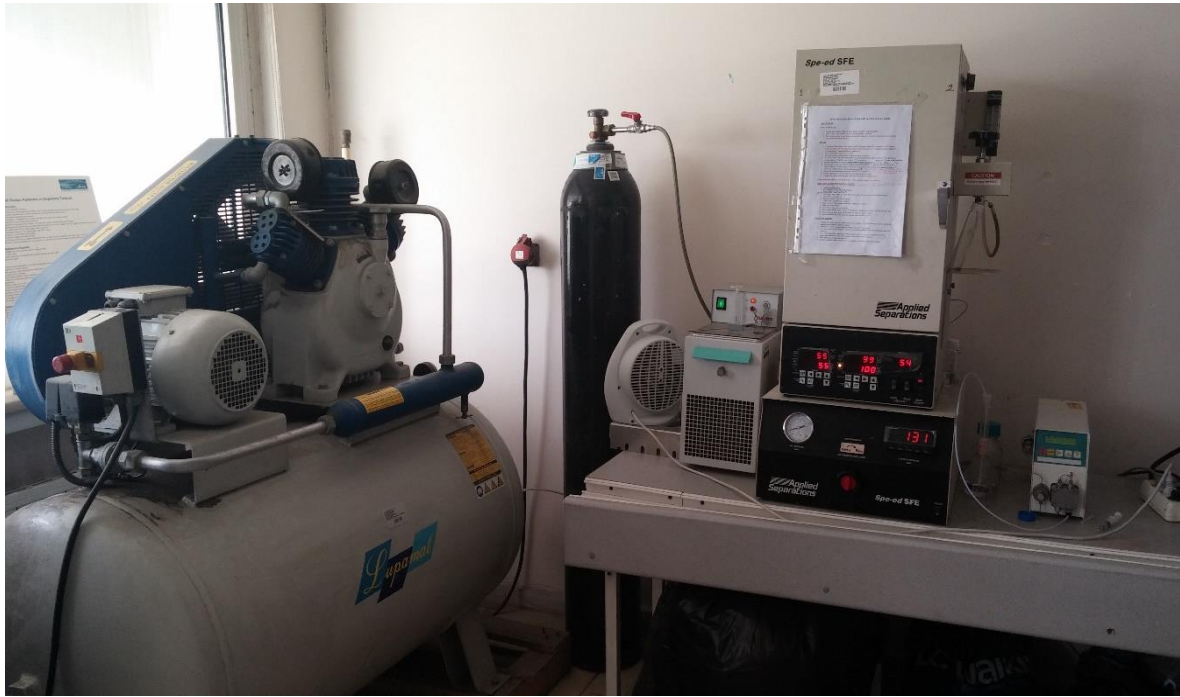
Resim 4.2. Süperkritik karbondioksit ekstraksiyon cihazı ve deney düzeneği
