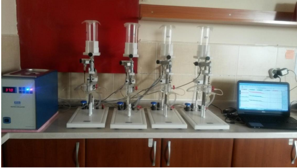
Şekil 3.1. İzole organ banyosu sistemi.
