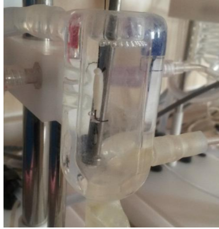
Şekil 3.4. İzole organ banyosuna yerleştirilmiş mesane düz kas şeridi
