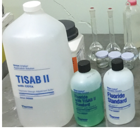
Şekil 3.15: Çalışmada kullanılan florid standardı ve TISAB II
