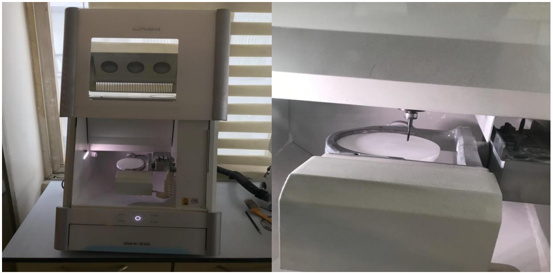
Resim 3.5: Roland dwx51d cihazıve kazıma işlemi
