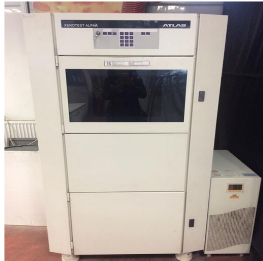
Resim 3.13: Hızlandırılmış yaşlandırma; Atlas Xenontest Alpha high energy weather device
