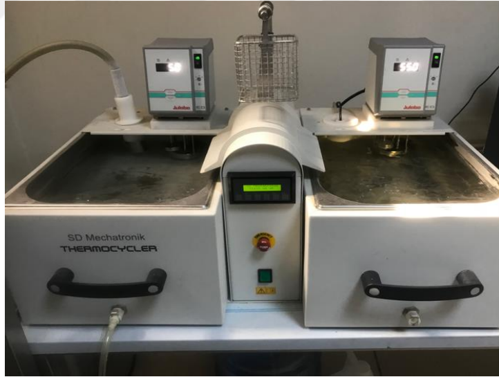
Resim 3.14: Termal döngü ile yaşlandırma; SD Mechatronik Thermocycl
