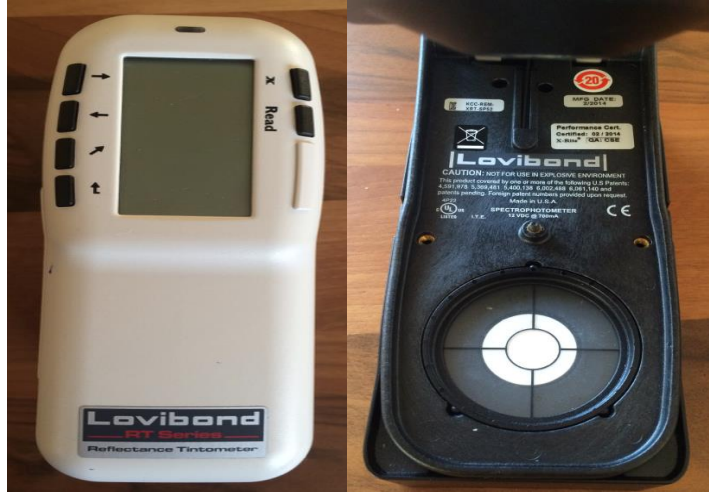
Resim 3.16: Renk ölçümlerinde kullanılan spektrofotometre; Lovibond RT Series Reflectance Tintometer
